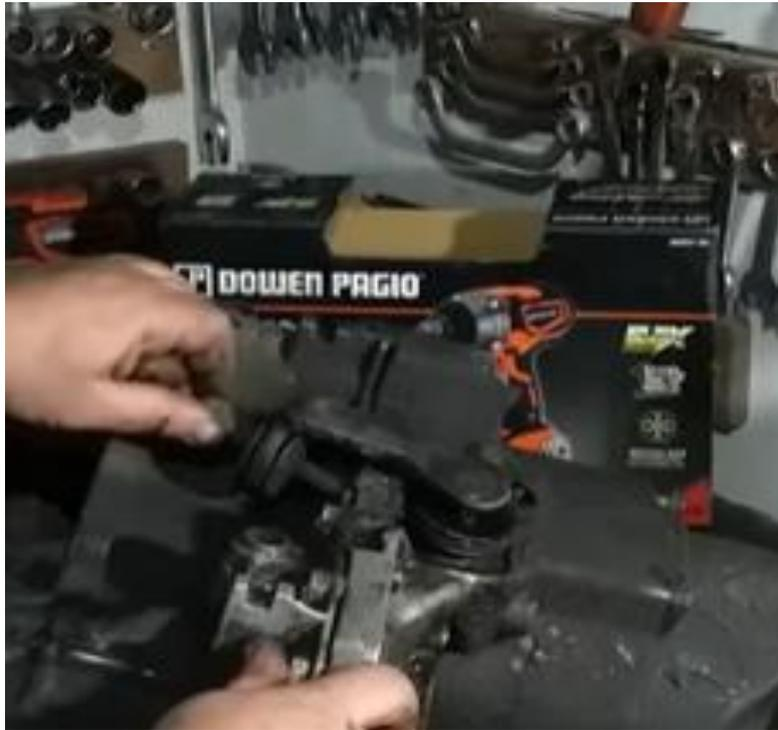
*Nota.* Proceso de extracción de la palanca selectora de cambios
