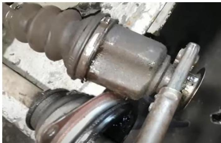
*Nota.* Proceso para sacar el guardapolvo del eje de transmisión.
