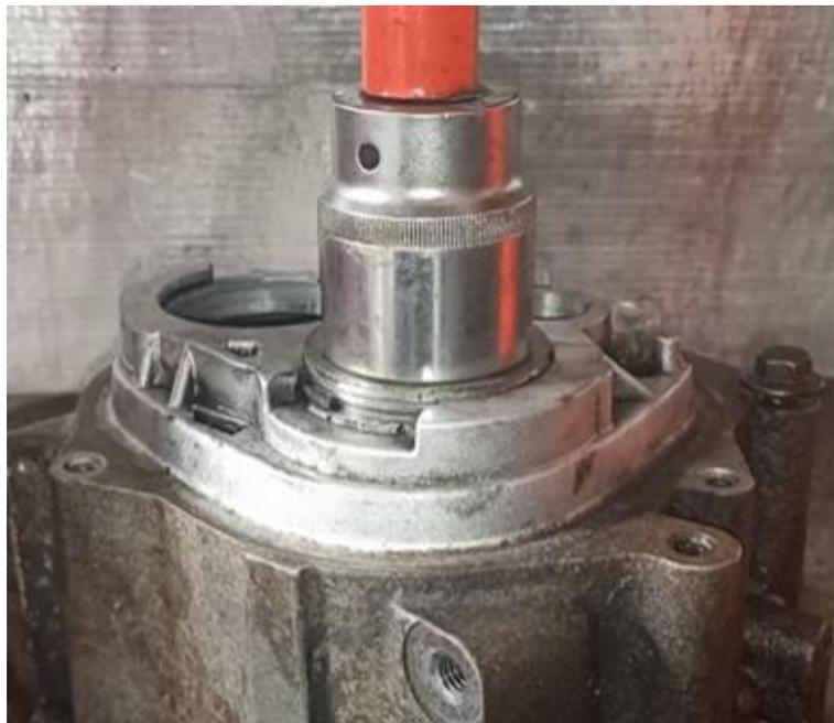
*Nota.* Muestra gráfica de la extracción de un rodamiento.
