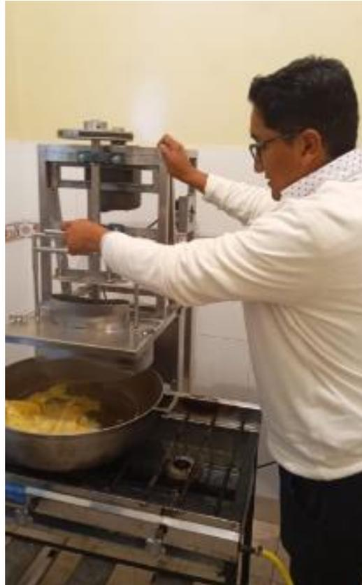
Finalmente verificamos que el corte es el correcto el verde cortado cae directamente en el aceite hirviendo y obtenemos el chifle tal como se muestra en la Figura 60, que la máquina funciona correctamente durante su operación
