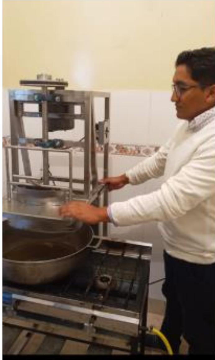
Encendemos la máquina para empezar con el corte del plátano verde según la Figura 59 este lo realizamos varias veces para verificar que el equipo funcione correctamente y garantizar que se entrega un equipo en óptimas condiciones.
