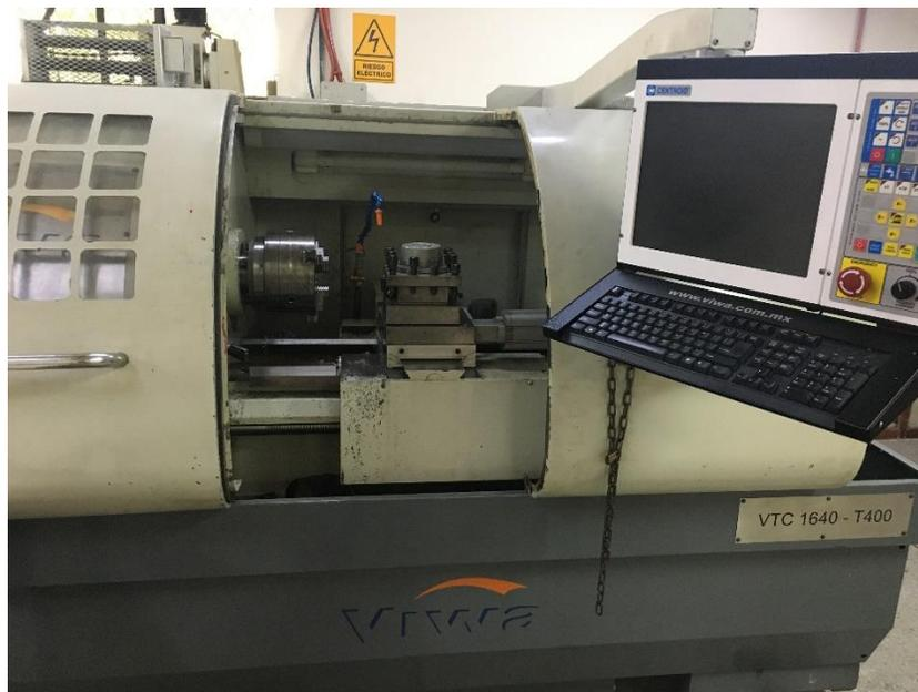
*Nota.* Torno paralelo CNC VTC 1640-T400, velocidad de rotación máxima de 3000 rpm, distancia entre puntos de 1000mm.
