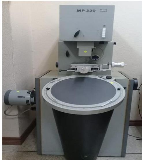
Con la ayuda del proyector de perfiles se pudo comparar y medir el desgaste que tiene cada una de los insertos utilizados en los ensayos, para lo cual fue necesario realizar un patrón (contorno de un inserto sin desgaste) de verificación (Ver Figura 28).
