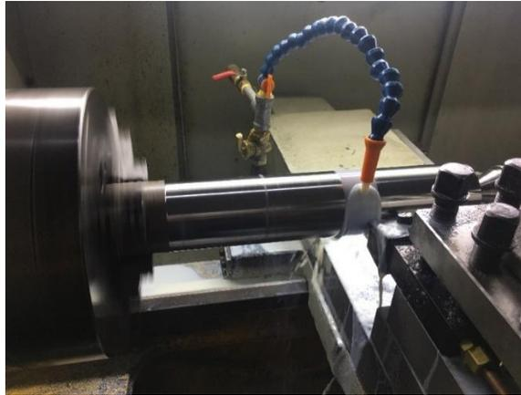
*Nota.* Proceso de torneado de un eje de aluminuro de titanio Ti-48Al-2Nb-0.7Cr-0.3Si;  $V_c=20\text{m/min}$ ;  $a_p=0,1\text{ mm}$ ;  $f=0,1\text{ mm}$ .
