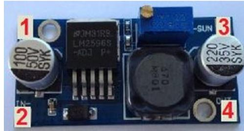
El pin 1 es la entrada positiva de los 12 voltios de la batería, este pin está conectado a un diodo de 3A el cual brinda protección en caso de que los terminales de la batería sean conectados de manera opuesta, el pin 2 es la entrada negativa de la batería o GND, el pin 3 es la salida que se puede regular con precisión gracias al potenciómetro que tiene incorporado, esto permite obtener un voltaje exacto a la salida del convertor y por último el pin 4 es la salida negativa del convertor o GND.
