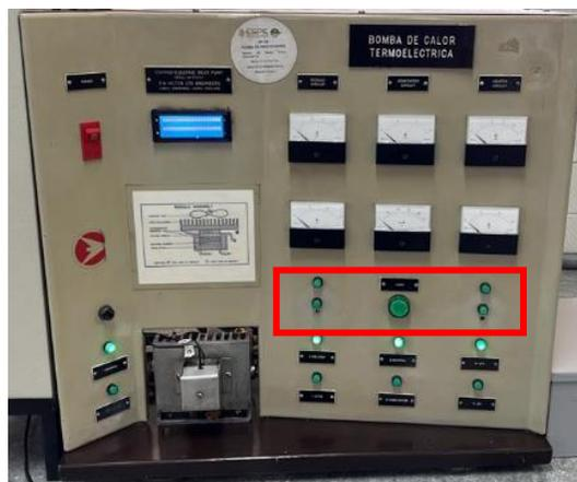
Para tener una mejor visualización de los datos de voltaje, amperaje y temperatura según la práctica que se esté realizando, se implementó una pantalla LCD de tamaño 20x4, donde se podrá visualizar estos datos mencionados anteriormente además de poder visualizarlos en los elementos de medición montados en el equipo antes de la intervención.
