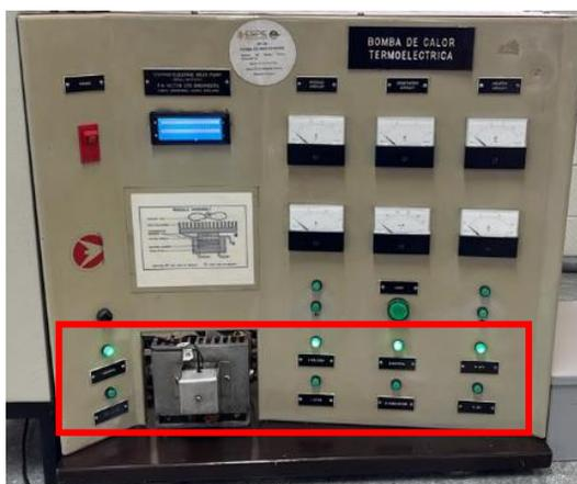
La variación de la potencia suministrada a los circuitos del módulo y del calentador antes de la intervención se lo realizaba variando la resistencia a través de reóstatos montados en la parte frontal del equipo como se puede observar en la siguiente figura.
