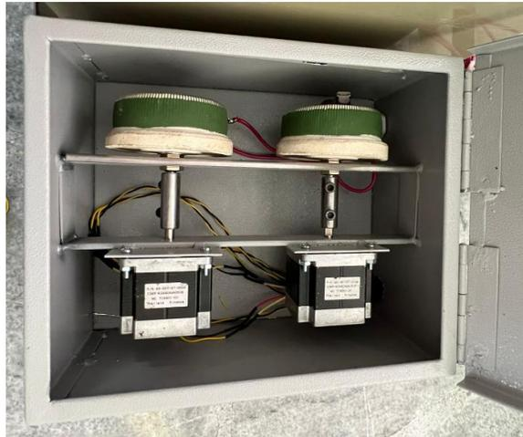
El movimiento del motor a pasos será trasladado a los reóstatos a través de bocines que garantizan el movimiento del motor a pasos sobre el reóstato dependiendo del circuito a utilizarse. Esta conexión se lo puede observar en la siguiente figura.
