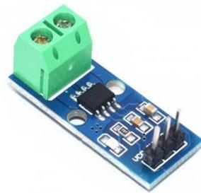
*Nota* Esta figura muestra a un sensor de corriente utilizado con la placa Arduino. Tomado de Anasi, V.(2021, 16 de mayo). *Sensor de corriente Acs712 con Arduino*. <https://microlab.ec/blog/sensor-de-corriente-ac712-con-arduino/>
