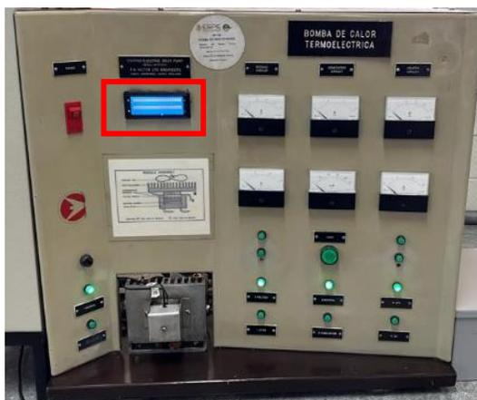
El rediseño del panel frontal se lo realizó utilizando el panel frontal perteneciente al equipo, es decir únicamente se lo modificó para ubicar los nuevos elementos de visualización y eliminar los previamente usados. Para esto se realizaron varias perforaciones y cortes en el panel frontal de la bomba de calor termoeléctrica.
