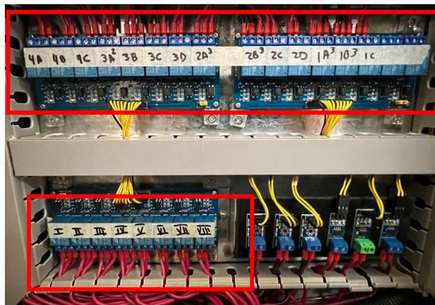
Para el reemplazo del interruptor 1 del equipo, para seleccionar "Normal" o "Seebeck", fue necesario la utilización de 3 bobinas ya que el interruptor existente disponía de 9 pines, indicando 3 estados para normalmente abierto y 3 para normalmente cerrado.
