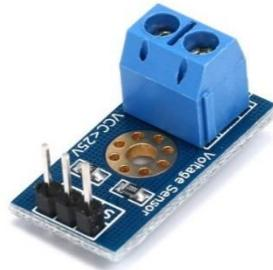
*Nota* Esta figura muestra a un sensor de voltaje utilizado con la placa Arduino. Tomado de Arrieta, V. (2019, 25 de enero). *Sensor de voltaje FZ0430 con Arduino*.
