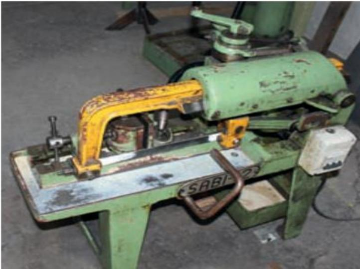
*Nota.* La figura muestra una sierra alternativa utilizada para el corte de ejes de acero. Obtenido de: *Técnicas Básicas De Mecanizado* (p. 12), por J. Bertol, 2019, Macmillan Education.
