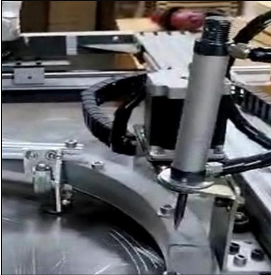
La Figura 61 muestra al pisador neumático fijado al cabezal del porta sierras superior, el pisador está compuesto por un cilindro de doble vástago y un rodillo en su base. La función del pisador es eliminar las vibraciones de la máquina producidas por el vaivén de la sierra al momento de realizar el corte.
