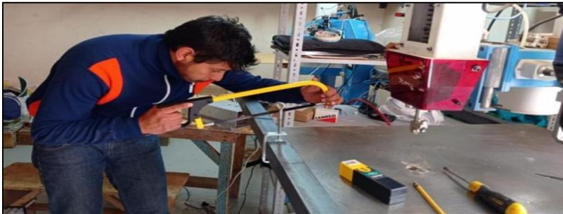
En la **Figura 49** se muestra el corte de la pieza de Alucobond de 4 [mm], que da soporte y une el aro giratorio con los carros de perfil tipo C, correspondientes al eje X. De acuerdo con el diseño y planos de construcción se procedió con la realización de agujeros y posterior fijación de esta base con los elementos del eje de rotación.
