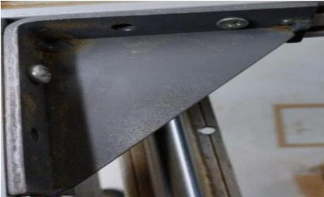
En la Figura 51 se observa el diseño de un ángulo tipo C que sirve de soporte y anclaje para el motor del eje de rotación. La pieza consta de dos ángulos de aluminio empernados entre sí, formando una C que permite ingresar el piñón en el eje del motor.
