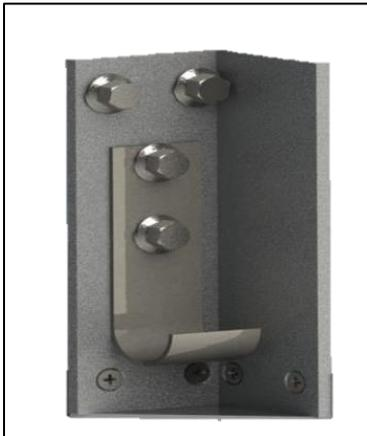
En la Figura 60 se observa el anclaje del cilindro neumático al sistema, mediante un ángulo de aluminio fijado a la placa que sostiene la rueda dentada, este cilindro funciona como punzador sobre la rueda dentada, el mismo que bloquea el movimiento y evita la pérdida de pasos en el eje de rotación. El cilindro se activa cuando el sistema corta en línea recta.
