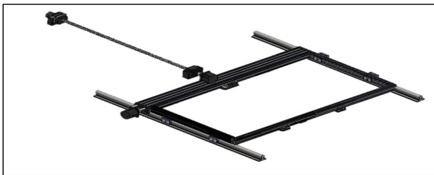
Para el dimensionamiento de cada elemento se debe tomar en cuenta las fuerzas que actúan sobre el eje Y. En la Tabla 10 se describe los elementos que conforman este eje con su respectivo peso. Por otro lado, al no conocer de manera exacta el peso correspondiente a cada elemento y con la finalidad de asegurar un buen dimensionamiento mecánico se considera un factor de seguridad de 1.2.
