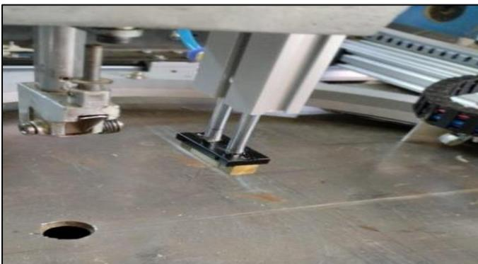
Los finales de carrera tipo rodillo y varilla anclados a las bases de las guías lineales, que limitan el área de trabajo se pueden ver en Figura 62 y sirven como elementos de seguridad al momento de la delimitar del espacio de trabajo.
