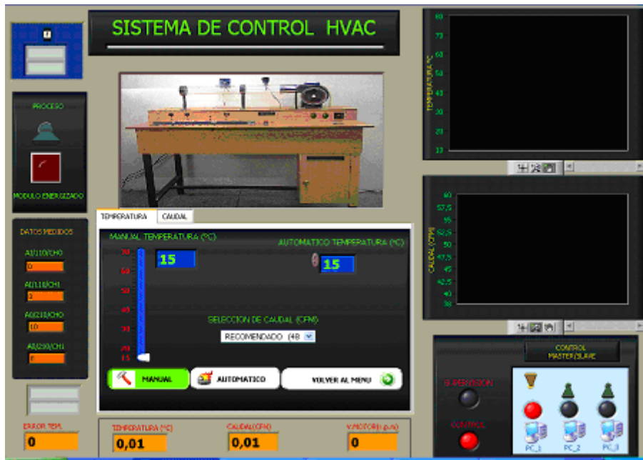
FIGURA No.9 Panel Frontal Operación del Modulo.
