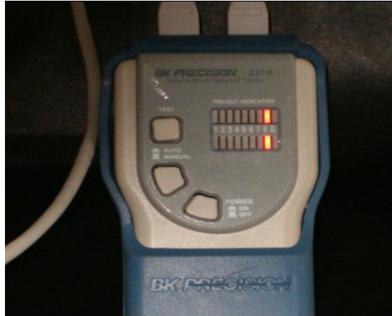
FIGURA No 4.2 Grafica de los Leds encendidos Paralelamente.
