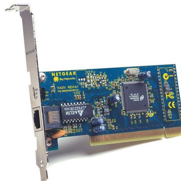
FIGURA No 2.11 Grafica de la tarjeta de red Ethernet.
