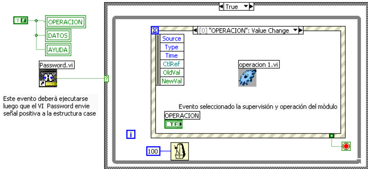
FIGURA No 3.3 Diagrama de bloques del Panel Frontal Principal.
