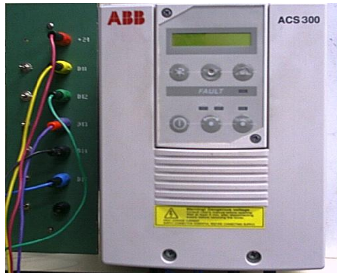
FIGURA No 3.37 Variador de Frecuencia ABB.
