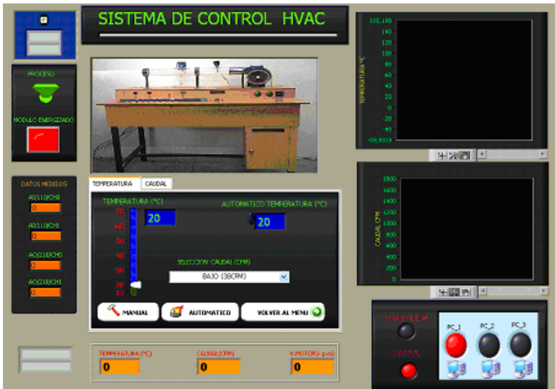
FIGURA No 3.17 Gráfica del panel frontal de Supervisión.
