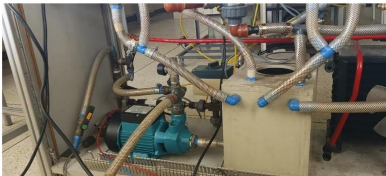
Nota: Adaptación de la bomba centrífuga AC P2 realizada en el presente trabajo de titulación
