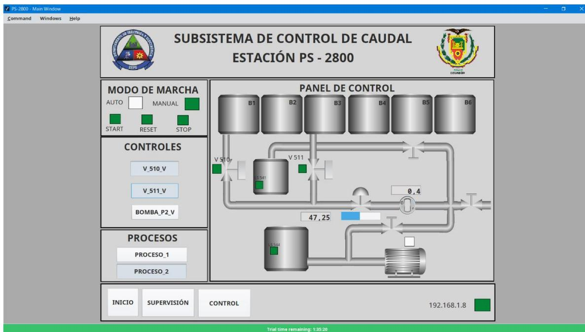
Nota: Obtenido de la interfaz HMI desarrollada para el control y supervisión del subsistema de control de caudal.
