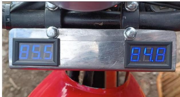
*Nota.* En la figura se observa dos indicadores de voltaje de corriente directa conectados a las dos baterías para mejorar el monitoreo en tiempo real.
