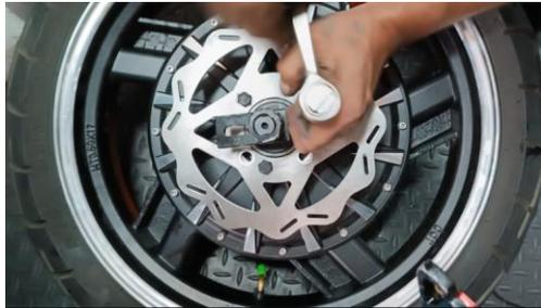
*Nota.* La figura representa el disco de freno de la motocicleta que esta acoplado al motor mediante el diseño del soporte de sistema de freno.
