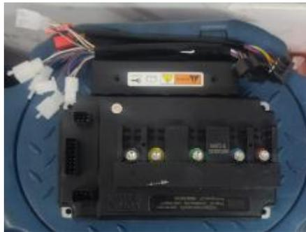
*Nota.* La figura representa la controladora de sistema de propulsión eléctrico que trabaja a 72v con tres líneas de entrada de motor eléctrico
