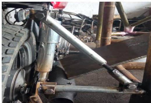
*Nota.* En la figura se muestra las sujeciones que van sujetas a prototipo y son desmontables por medio de pernos y están diseñadas para un reglaje.
