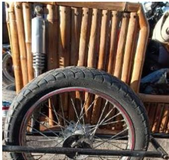
*Nota.* La figura muestra la suspensión del tricar mediante un amortiguador y un cuadro que oscila en su propio eje.
