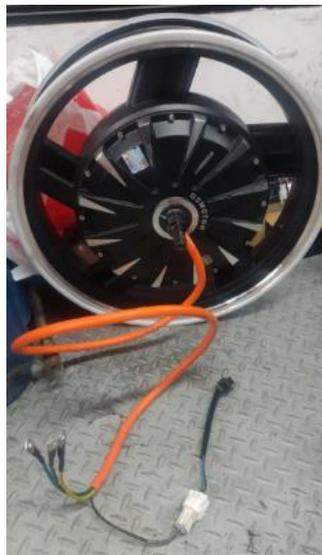
*Nota.* La imagen representa un motor cubo de doble eje con rin de 17 pulgadas 3000w QS
