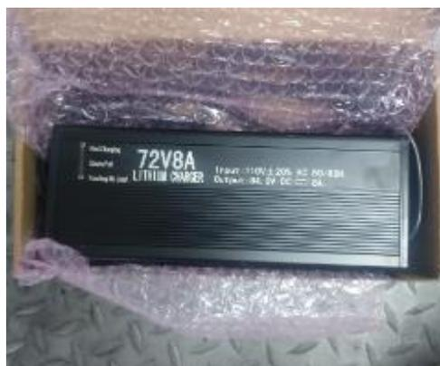
*Nota.* La figura representa el cargador de carga rápida para las baterías de litio con capacidad de 72V 8A.
