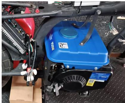
*Nota.* Planta generadora en la parte inferior del bastidor de la motocicleta está sujeta mediante dos soportes inferiores y dos soportes superiores.
