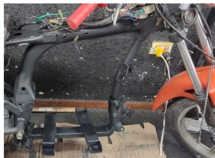
*Nota.* Construcción de una base de perfiles cuadrados para el motor generador.
