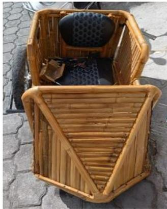
*Nota.* La figura representa la construcción acabada de la estructura de bambú.
