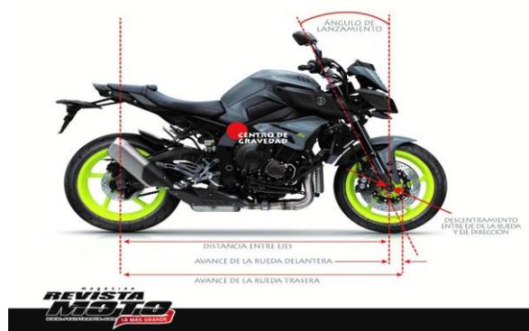
*Nota.* Ajuste de una motocicleta en la geometría. Tomada de (MotoRevista, 2017)
