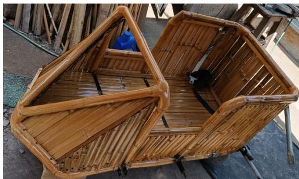
*Nota.* Aplicación de bambú en una estructura automotriz en estado completo y por partes.
