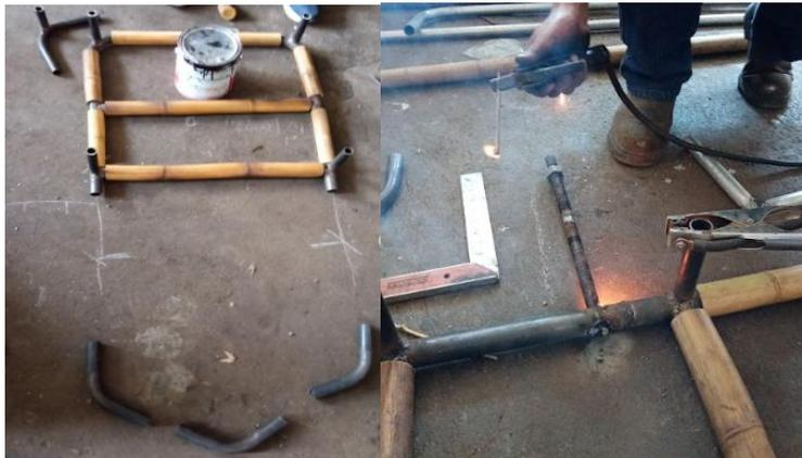
*Nota.* En la figura observamos el proceso de soldadura a la estructura del tricar y bastidor, se realiza toda la perfileria para luego armar.
