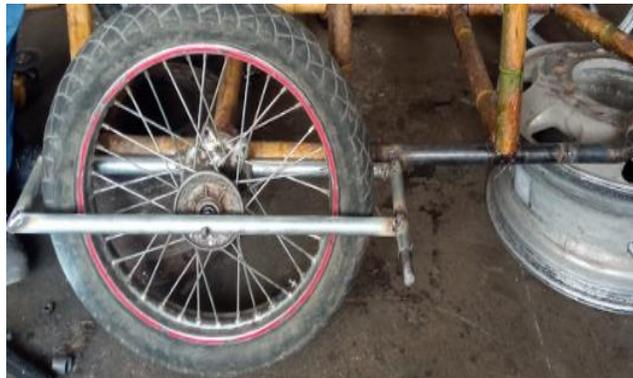
*Nota.* En la figura se muestra la construcción de la base de neumático en la parte izquierda del prototipo que tiene un eje fijo y oscilación de amortiguación.
