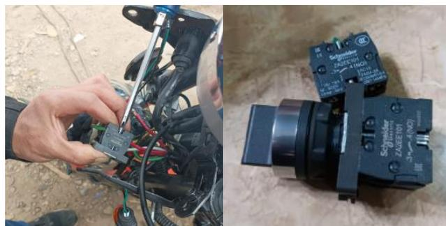
*Nota.* Conexión del selector de tres posiciones con la entrada de tres vías y tres vías de salida.
