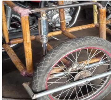
*Nota.* Base del amortiguador unido a la perfilera del prototipo y a la base del neumático.
