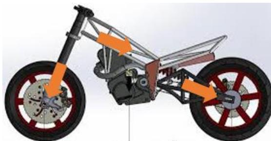
*Nota.* En la figura se muestra cómo actúan las cargas transversales en el bastidor de la motocicleta.
