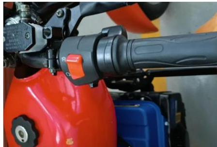
*Nota.* La figura nos muestra el acelerador que tiene entrada de 5 voltios.
