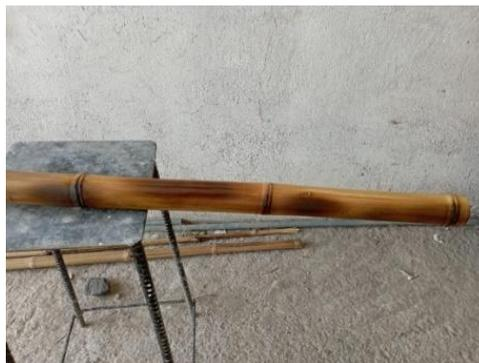
*Nota.* En la figura observamos el tratamiento del bambú mediante el quemado por medio de soplete para quitar la humedad.
