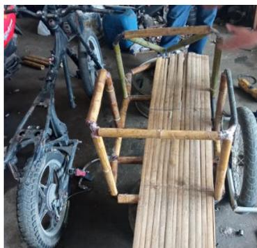
*Nota.* Montaje de una plancha de bambú cortado para medir y cortar en las medidas diseñadas
