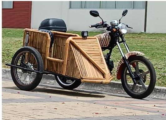
*Nota.* En la figura se observa un vehículo tricar propulsado por un motor eléctrico y un sidecar a lado derecho con estructura de bambú.
