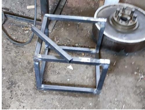
*Nota.* Proceso de soldadura y pulido de la estructura
