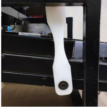
Se coloca los 4 péndulos, uniendo la estructura de la zaranda con las bandejas.
