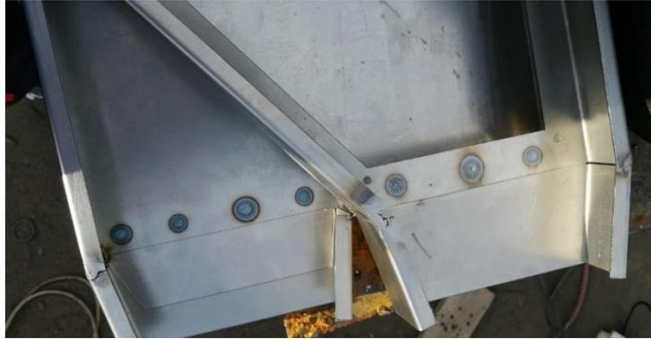
*Nota.* Soldadura de contacto para unir las salidas de las bandejas
