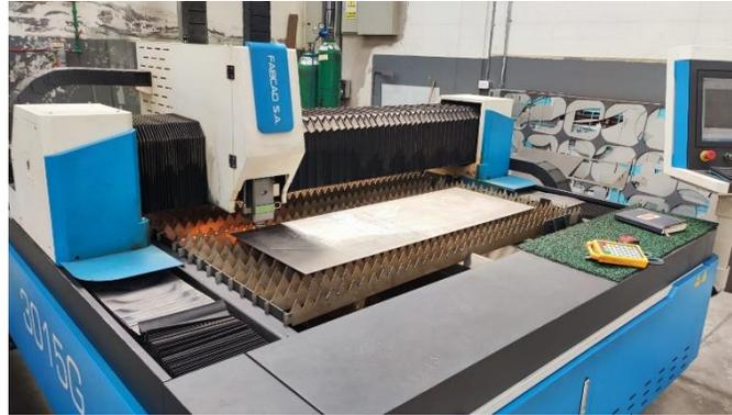
*Nota.* Corte laser de plancha de acero de 1mm de espesor
