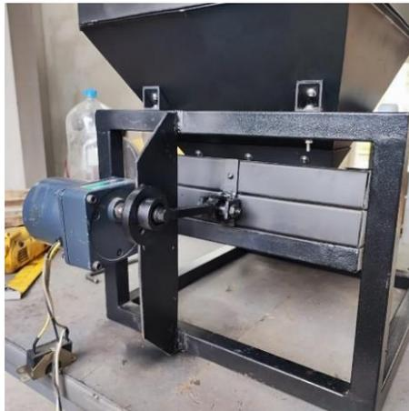
Instalar el sensor de proximidad capacitivo y ocultar el cable de transmisión de la señal para tener un ensamble limpio.
