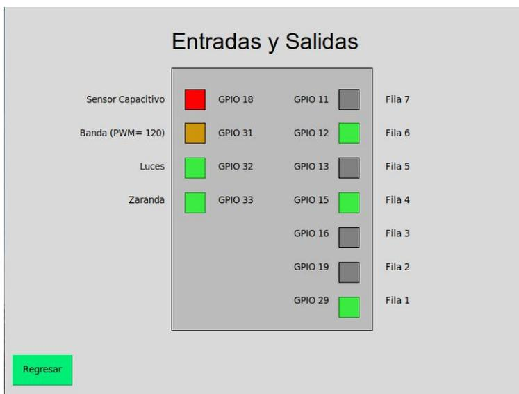
En la Figura 82 se puede diferenciar claramente en los indicadores de la derecha cuando el actuador de la fila correspondiente entra en funcionamiento, a la izquierda se puede observar cuando el sensor de proximidad capacitivo indica si existe o no chocho en la tolva, el led que indica el valor en valor en PWM asignado a la banda. Finalmente luces y zaranda se activan cuando el proceso está en funcionamiento.
