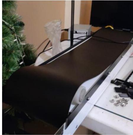
Ajustar correctamente el giro de la banda, templando las chumaceras para que no tope con los laterales de la estructura.
