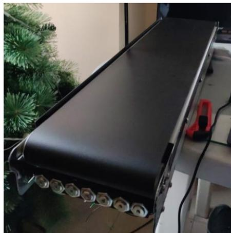
Una vez que se encuentran armados tanto zaranda como banda transportadora lo que resta por hacer es realizar cableado y conexiones dentro de la caja de control para la posterior instalación del sistema de visión artificial en la caja del mismo nombre y finalmente las pruebas de funcionamiento.
