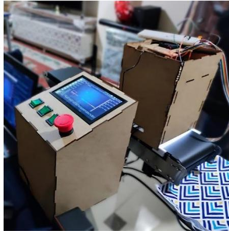
*Nota.* Fotografía de la caja de visión y caja de control ensambladas
