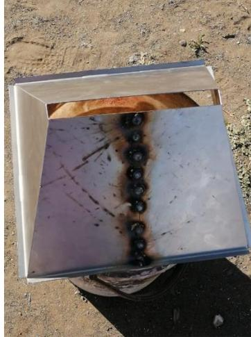
*Nota.* Soldadura realizada con puntos, con soldadura SMAW
