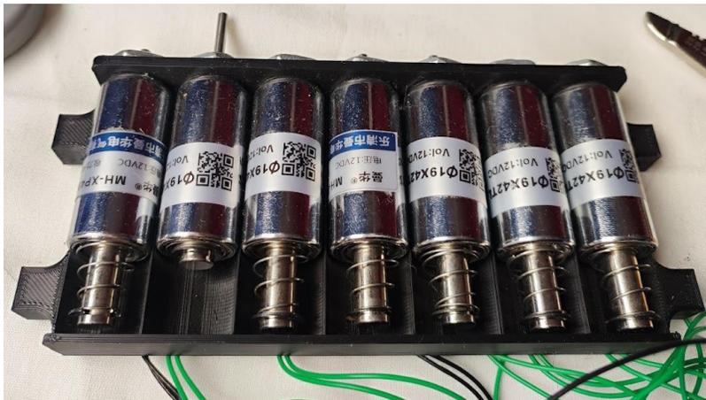
*Nota.* Fotografía de la estructura de actuadores electromagnéticos
