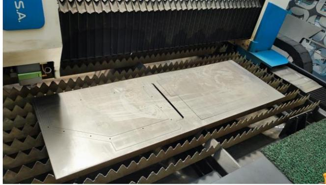
*Nota.* Fotografía de las bandejas cortadas con máquina de corte laser en plancha de acero
