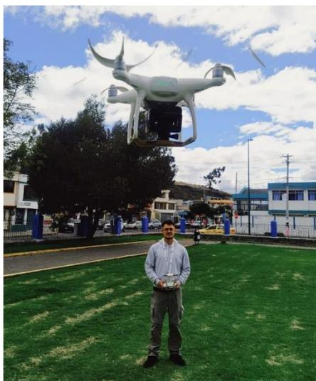
En función de estos resultados se optimiza aún más el diseño del soporte y del sistema de control a distancia (mismo que consta de un peso neto de 420 gramos), también se retira la cámara del drone y los sensores inferiores para obtener ganancia de peso (con lo que se reducen 200 gramos) siendo de tan solo 220 gramos extras al peso normal que experimentaría el drone en condiciones normales.
