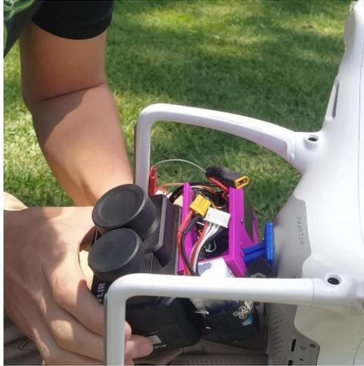
*Nota.* La figura muestra el sistema de control a distancia instalado en el morro del Drone
