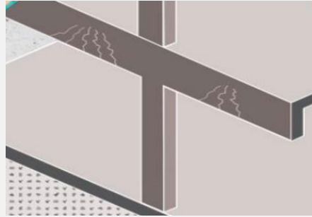
Insuficiencia de armadura negativa
