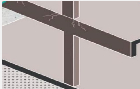
Insuficiencia de armadura negativa
