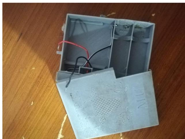
Después se propuso colocarlo en el cuello del bovino, está fue la mejor opción con la precaución de no ajustar demasiado la correa para no dañar o incomodar al animal, como se muestra en la Figura 28, adicional se mejoró la estructura de la caja del Emisor haciéndola más gruesa para que resista el movimiento del animal.
