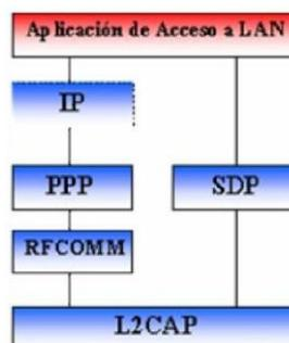
**Figura 2.7** Pila de protocolos para el modelo de uso de acceso a LAN
