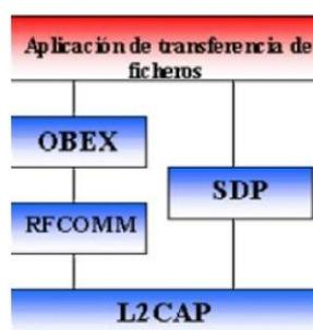
Figura 2.5 Pila de protocolos para transferencia de ficheros
