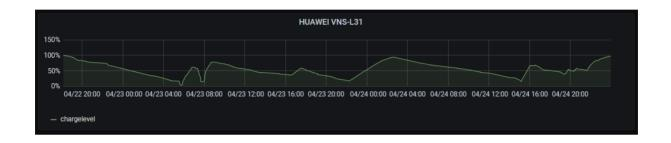
Nota. La figura representa el consumo de batería del dispositivo móvil HUAWEI VNS-L31, donde se puede visualizar que, los picos más altos son las 08H00 y a las 16H00 llegando aproximadamente a un 70% de carga y el mayor consumo de batería del dispositivo es en las horas de la mañana.
