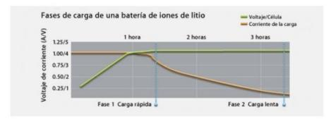
Nota. La figura representa las fases de carga de las baterías de iones Litio. Tomado de ¿Como cargar la batería de tu móvil correctamente? por Juan Cascón Baños, Frikipandi (https://www.frikipandi.com/tecnologia/20150313/como-cargar-la-bateria-de-tu-movil-correctamente/)
