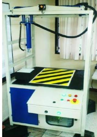
*Nota.* Robot cartesiano desarrollado para tareas de perforación y recabado de material, imagen tomada del Laboratorio de Robótica y PLC.
