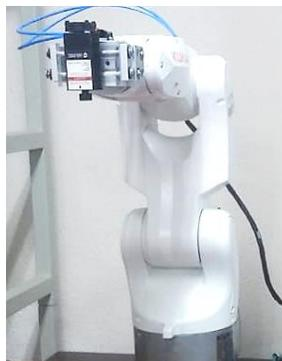
*Nota.* Robot KUKA KR3 R540, manipulador antropomórfico utilizado para realizar tareas de apilado, clasificación de materiales o pintura, imagen tomada del laboratorio de Robótica y PLC.
