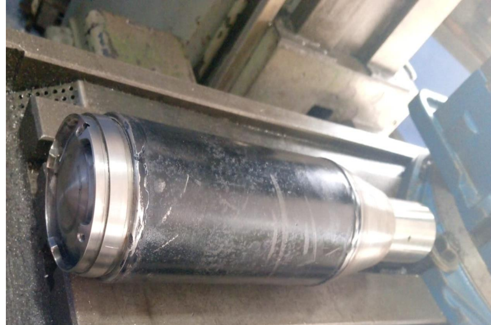
Cámara de combustión
