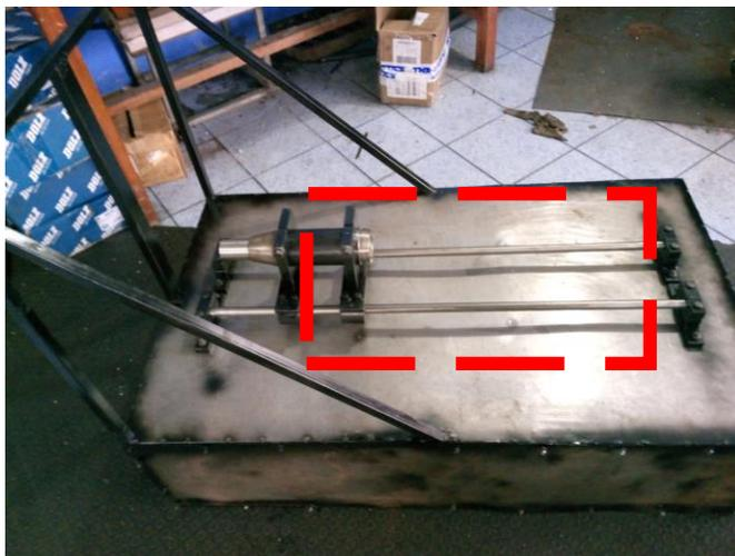
*Nota.* Ejes transversales del BEMCO donde se moverá la cámara de combustión.
