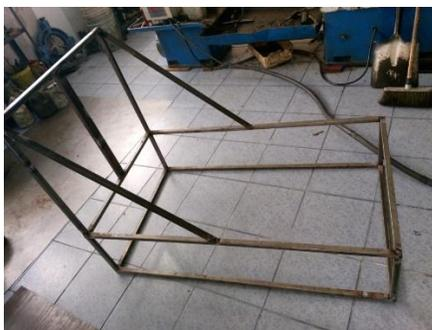
*Nota.* Elaboración del esqueleto del BEMCO en el taller solamente perfiles estructurales.
