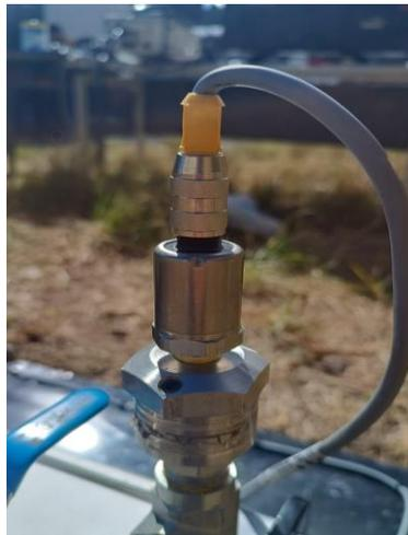
*Nota.* Transductor de presión instalado en el BEMCO
