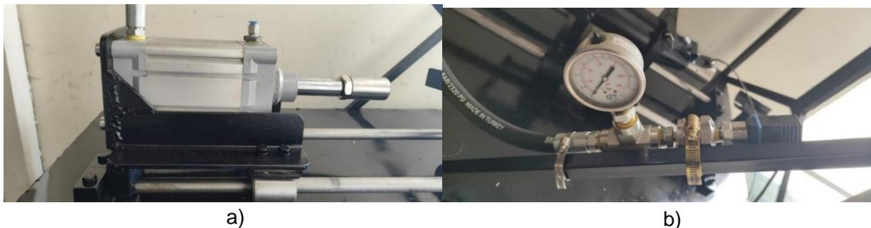
*Nota.* a) Montaje de embolo sobre rieles. b) Etapa de visualización de presión con manómetro y transmisor de presión.
