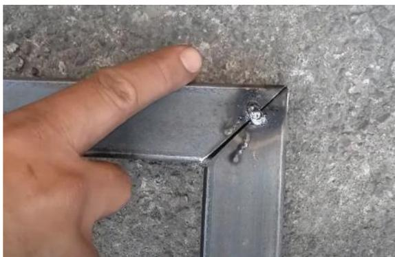
Se realizan todas las juntas soldadas hasta formar las estructuras especificadas en los planos, posteriormente, para tener un buen acabado se desbasta el exceso de cordón hasta que quede una superficie plana tal como se observa en la Figura 49
