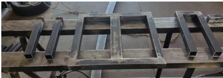
Para finalizar con esta etapa se ensamblan todas las partes hasta conformar la estructura base de la estación de triaje, además, ya no se requiere de ningún tipo de modificación mayor, por tal motivo también se pinta la estructura para evitar el desgaste de la superficie. En la Figura 50 se muestra la estructura base pulida (a) y pintada (b).
