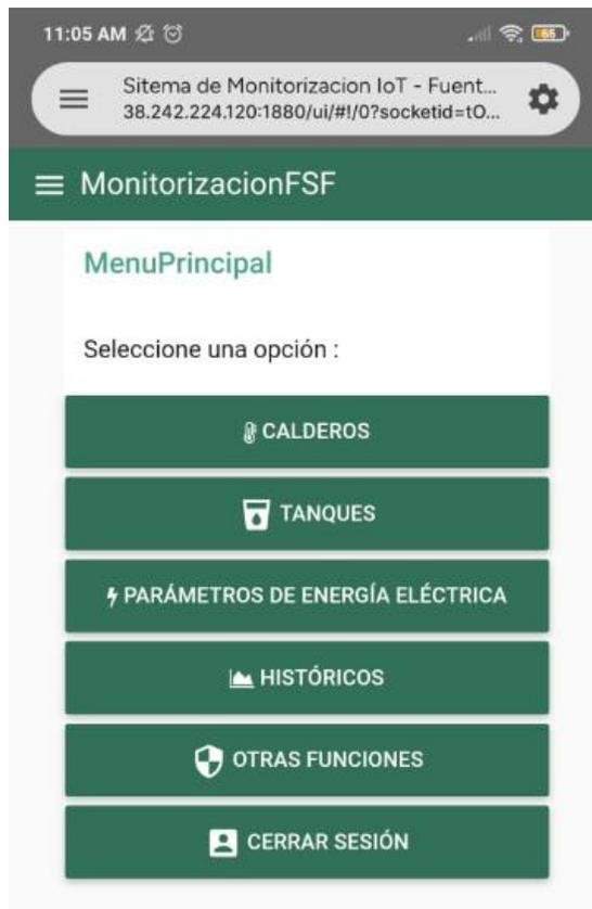
El segundo menú de navegación corresponde al menú que permite el acceso a los diferentes parámetros de energía eléctrica, los cuales están asociados al medidor de energía inteligente EasyLogic PM2120. Como se muestra en la figura 77, dentro de esta pantalla el
