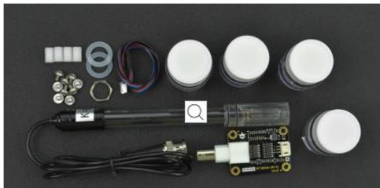
*Nota:* Se puede observar en la figura el kit del sensor, que incluye cuatro soluciones para la calibración. Tomado de (DFRobot, 2022).
