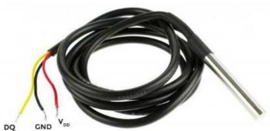
*Nota:* En la Figura se observa el sensor de temperatura el cual tiene 3 pines cable rojo (VDD), cable negro (GND) y cable amarillo (datos). Obtenido de (Hernández, 2020b).
