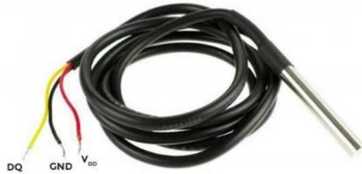
*Nota:* En la figura se puede ver la sonda del sensor de temperatura con el cubrimiento de acero inoxidable y sus tres cables para la conexión: amarillo para datos, rojo para VCC y negro para conexión a tierra. Obtenido de (Hernández, 2020a).
