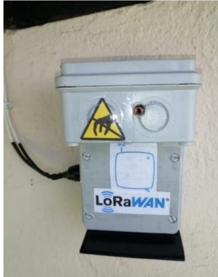
Para mayor seguridad del equipo se lo conecto a la caja de revisión de la electricidad para evitar cualquier daño por sobrecarga de voltajes, con la ayuda del multímetro se logró comprobar que exista el correcto voltaje para la conexión (Véase en la Figura 57)
