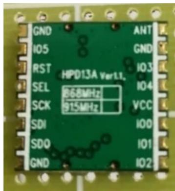
*Nota:* En el pin ANT se coloca la antena.
