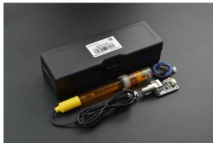
*Nota:* En la Figura se observa el sensor utilizado para la medición de ORP el cual consta de una sonda de 1 m y su respectiva placa. Obtenido de (DFRobot, 2020).
