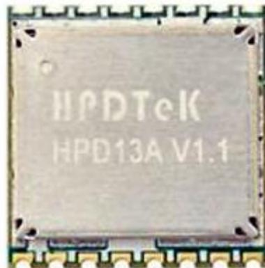
*Nota:* En la Figura se observa el módulo usado para la implementación, consta de 16 pines y conector para antena. Elaboración Propia
