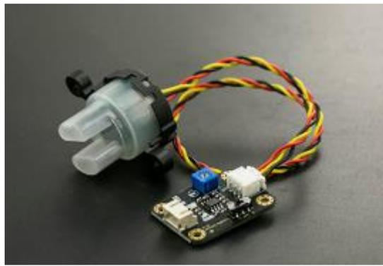
*Nota:* En la Figura se muestra el sensor de turbidez utilizado funciona a 5VDC, posee su propio modulo para conexión. Tomado de (DFRobot, 2022).
