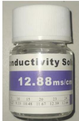
Para compensar las variaciones de la conductividad eléctrica ante la temperatura se utiliza un sensor de temperatura en conjunto con el sensor de conductividad eléctrica y así obtener valores más precisos. Se carga el código de calibración y se abre el puerto serial como se puede observar en la Figura 97.
