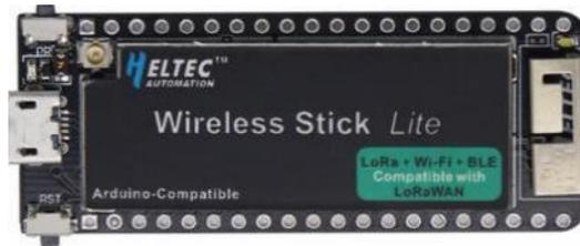
*Nota:* La Figura muestra el módulo LoRa que se utilizó para el envío de datos a las puertas de enlace en este caso uno sin pantalla y de la marca Heltec. Tomado de (Heltec, 2022).
