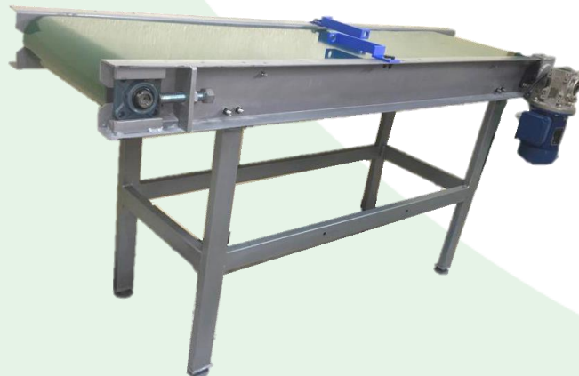
Montaje de la banda y rodillos
