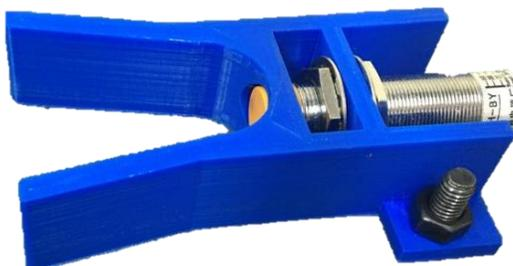
*Nota.* Pinza para ubicar la probeta y soportar el sensor capacitivo.
