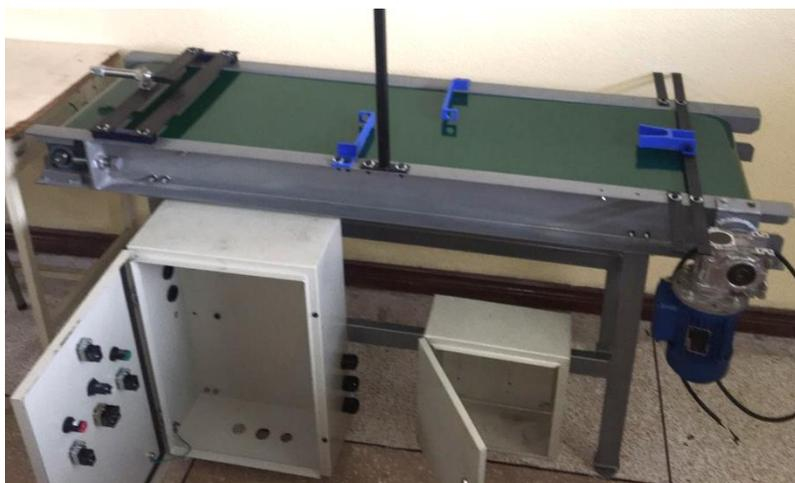
*Nota.* En la figura se presentan los tableros ubicados en el bastidor de la banda transportadora.
