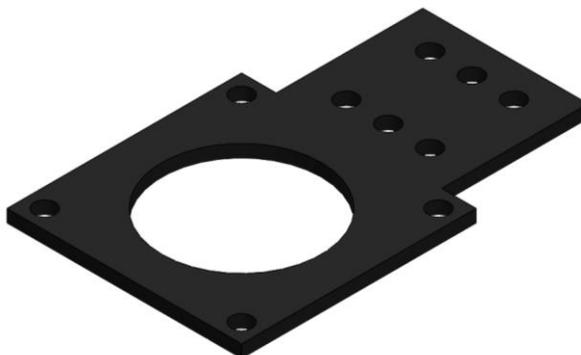
*Nota.* Soporte de MDF para acoplar el motor NEMA 23 al perfil V.
