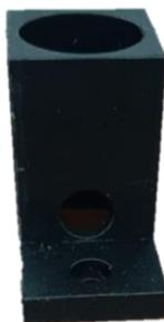
*Nota.* Soporte para guiar el dado y apilar las probetas.
