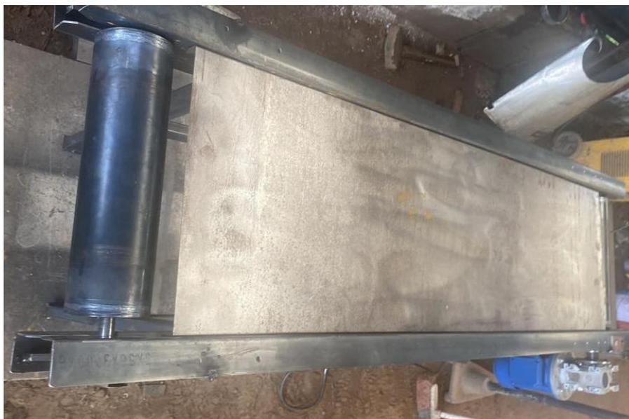
*Nota.* En la figura se presenta el montaje de la base deslizante de chapa metálica.
