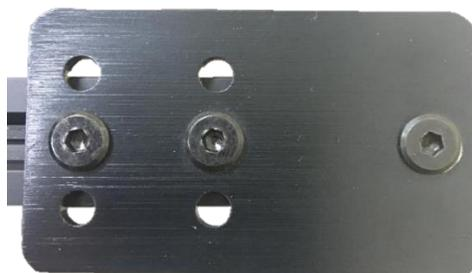
*Nota.* Placa soporte de aluminio para acoplar la polea conducida.
