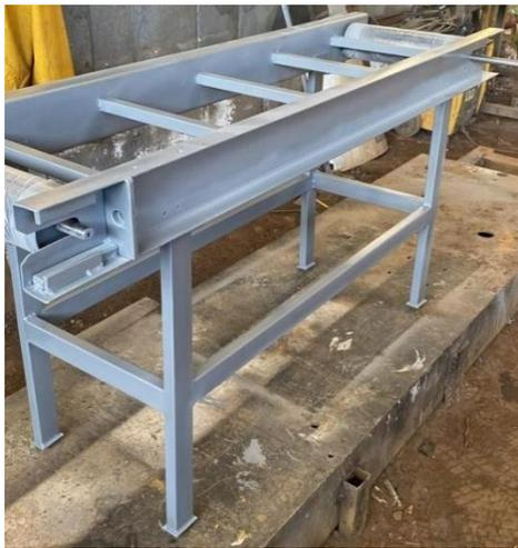
*Nota.* En la figura se presenta el bastidor de la banda transportadora.
