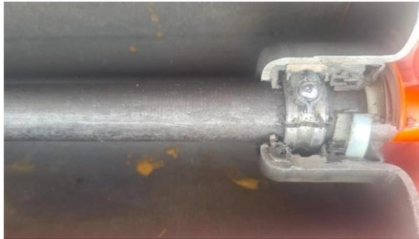
*Nota.* En la figura se muestra la composición interna del rodillo.
