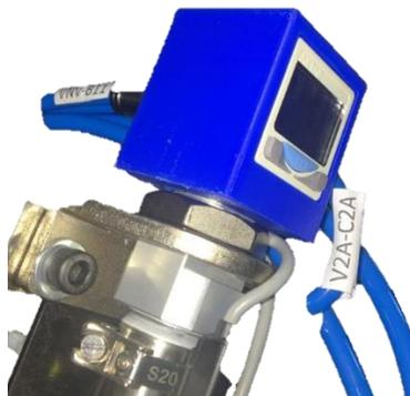
*Nota.* Soporte para el sensor de presión encargado de medir la presión de vacío.
