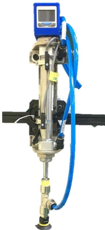
*Nota.* Cilindro acoplado al carrito montado en la estructura del subsistema del clasificador.
