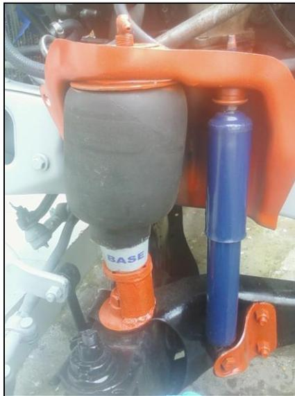
**Figura 7.8. Suspensión neumática delantera**
