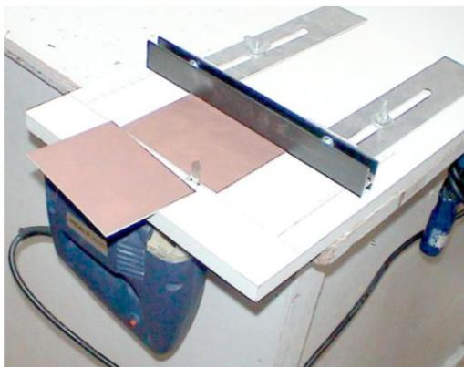
**Figura B.1. Selección y corte de la placa para diseño del circuito electrónico.**
