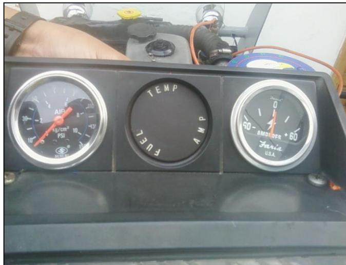
**Figura 7.15. Manómetros de control**
