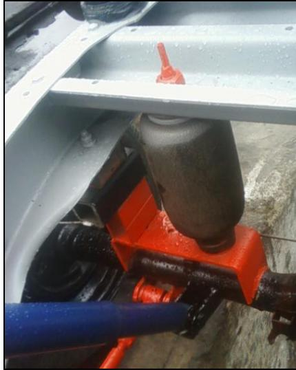
**Figura 7.9. Suspensión neumática trasera**
