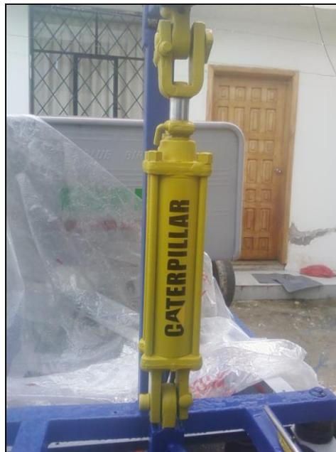
**Figura 7.4. Cilindro hidráulico**
