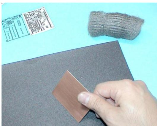
**Figura B.2. Preparación de la placa**
