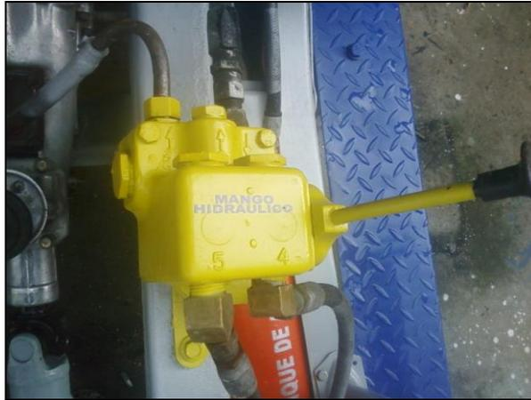
**Figura 7.6. Válvula de mando o control**
