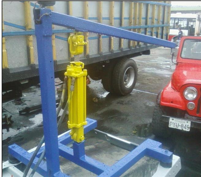
**Figura 7.1. Brazo hidráulico**
