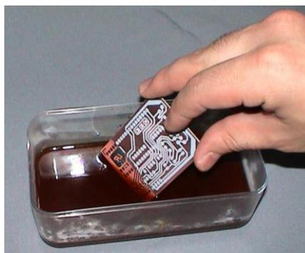
**Figura B.6. Trazado del circuito en la placa mediante acido**
