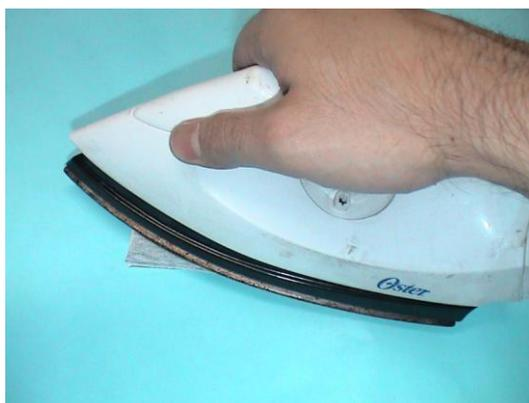
**Figura B.3. Transcripción del circuito a la placa mediante transferencia térmica**
