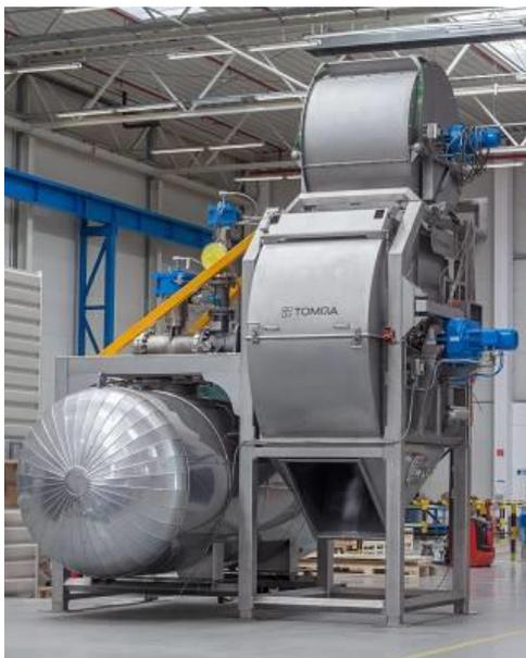
*Nota.* Para su operación, las peladoras de vapor requieren un consumo significativo de energía, ya que se debe generar la temperatura adecuada, durante un ciclo amplio de tiempo para la producción de vapor. Tomado de “Peladoras de frutas y hortalizas” (<https://interempresas.net>)
