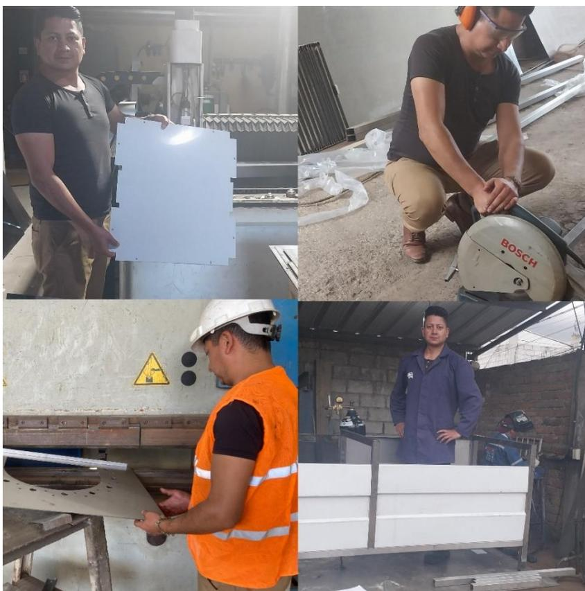
*Nota.* El proceso general de construcción se lo puede describir con esta imagen, y consta de corte láser de planchas de 2mm y 0.7 mm, corte de perfil cuadrado 1 ½ in, doblado de cortes, y ensamblado de acuerdo con los planos presentados. Toda la máquina se ha construido en acero 304 para cumplir con normativa de alimentos.
