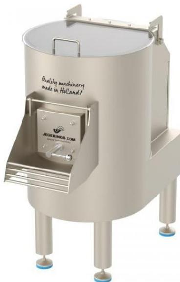
*Nota.* Peladora de cuchillas de acero inoxidable para pelado de verduras como papas, apionabo, colinabo, etc. Capacidad de pelado de 15-20 kg por ciclo que dura entre 1-5 min. Tomado de “Manual peladora de cuchillas MSM-20 – Jegerings”
