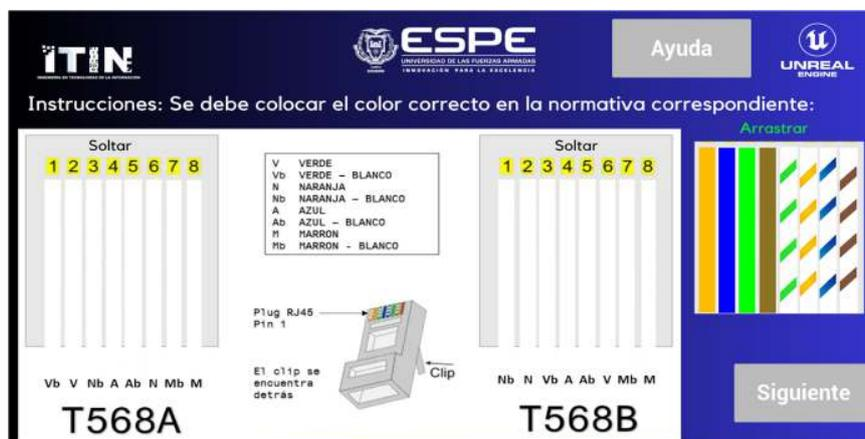
*Nota.* En la figura se puede visualizar un tutorial donde se muestra el escenario de ordenar los hilos según su código de colores de las normativas T568-A y T568-B, el desafío consiste en completar correctamente el código de colores para avanzar al siguiente nivel. Elaborada por: Bismark Castro, 2023.
