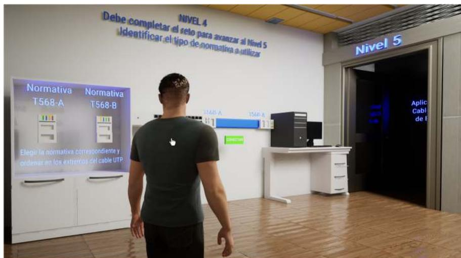
*Nota.* En la figura se muestra el reto completado correctamente donde al definir el tipo de normativa a utilizar en cada extremo se abre la puerta, debe ser cable directo ya que son dispositivos diferentes por lo que en un extremo debe ser la normativa T568-A y el otro extremo la normativa T568-A o la normativa T568-B y el otro extremo la normativa T568-B.
