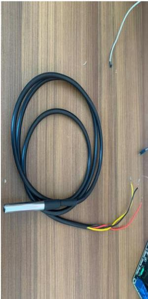
*Nota.* Sensor utilizado para medir la variable de la temperatura del agua. Los valores óptimos de temperatura de agua rondan los 10 a 20 grados. Fuente: Elaboración propia.
