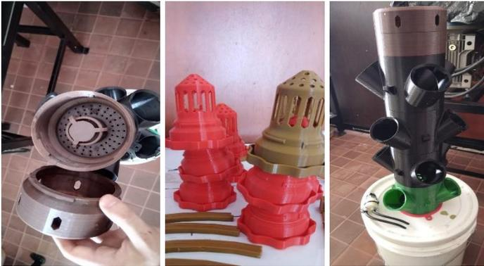
*Nota.* Se observan los modelos ya impresos con filamento PLA que serán usado para armar el sistema hidropónico. Fuente: Elaboración propia.
