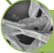
Se recomienda realizar microscopía electrónica de barrido para observar las localizaciones de los metales pesados dentro del sistema hifal y así observar diferencias en su morfología.
