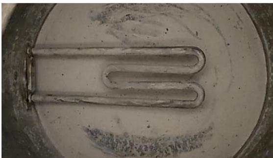
Cabe mencionar que la niquelina fue cambiada por una nueva del mismo tipo posterior a realizar varios ensayos, debido a que perdió sus características térmicas de funcionamiento.
