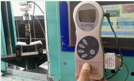
Figura 16 a) Máquina de ensayo de flexión laboratorio de mecánica de materiales ESPE b) Curva esfuerzo – deformación de probeta de PLA
