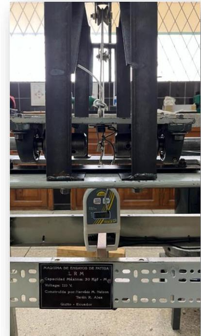
**Figura 9.** Calibración máquina R.R. Moore
