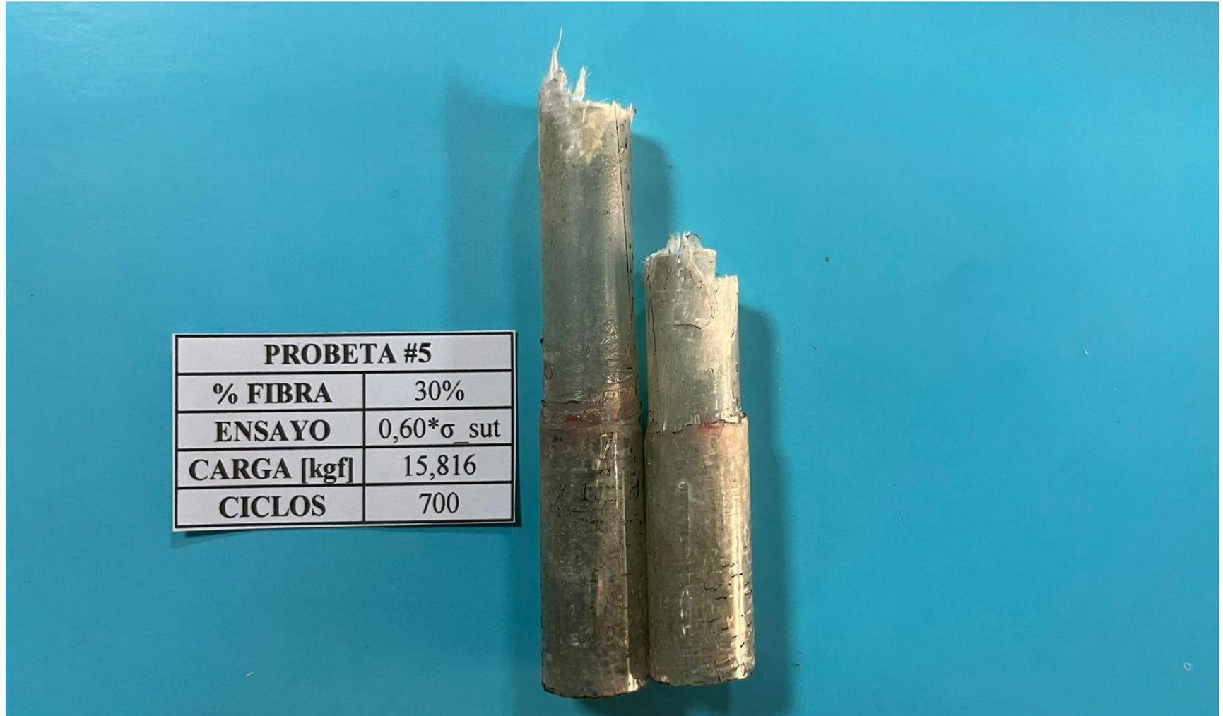
Figura 16. Rotura Probeta #5 –  $V_f=30\%$
