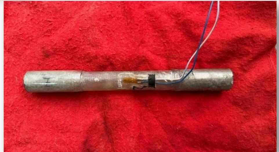
**Figura 11.** Strain Gages en probeta de MC
