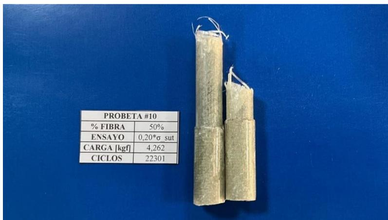
**Análisis:** En la figura #48, la probeta trabajó al 20% del esfuerzo último a tracción, la falla se produjo a los 22301 ciclos con una carga aplicada de 4,262 [kgf], la rotura se generó por su total desprendimiento de la fibra en dirección longitudinal.
