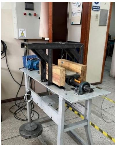
Según estudios previos, se ha realizado ensayos en probetas de material Duralón, obteniéndose buenos resultados, para lo cual, se estudiará el comportamiento de materiales compuestos a base de fibra de vidrio con resina de poliéster ante cargas dinámicas, de manera que, se obtengan las curvas de esfuerzo versus vida.
