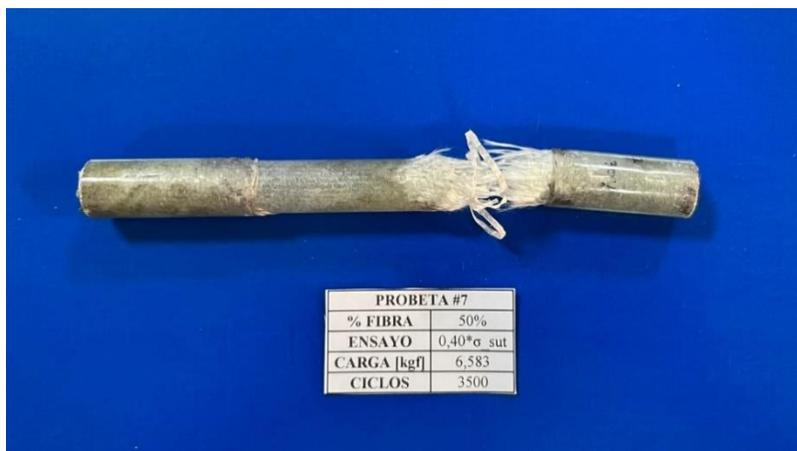
**Análisis:** En la figura #47, la probeta trabajó al 40% del esfuerzo último a tracción, la rotura se produjo a los 3500 ciclos con una carga aplicada de 6,538 [kgf]; la rotura se produce por falla de la matriz (resina) en dirección longitudinal ubicada a un extremo de la probeta.
