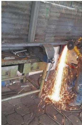
El corte se realiza en los puntos marcados, poniendo énfasis en el corte biselado de las bases para posteriormente ser doblados con apoyo de la entenalla.
