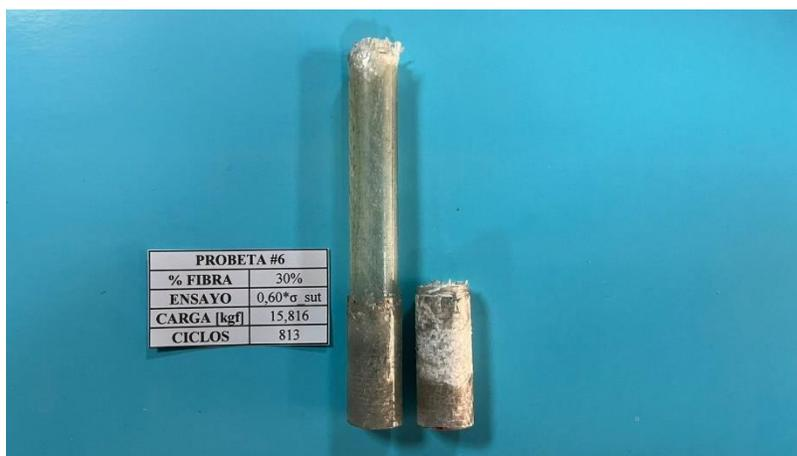
**Análisis:** En la figura #56, la probeta trabajó al 60% del esfuerzo último a tracción, la falla por rotura se produjo a los 813 ciclos con una carga aplicada de 15,816 [kgf], la rotura se generó en el inicio del área de trabajo provocando una separación total con del diámetro de refuerzo, la fibra cedió ante la carga aplicada.
