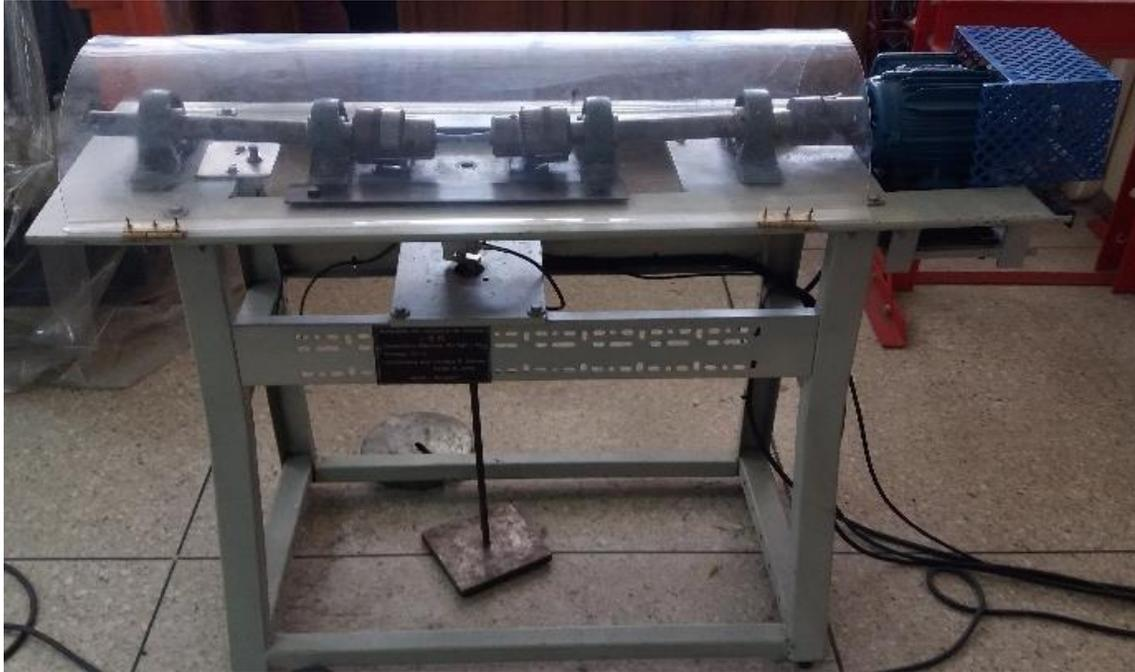
Los elementos que integran una máquina de ensayo de fatiga de flexión rotativa de tipo R.R. Moore, son:
