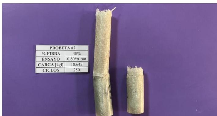
**Análisis:** En la figura #50, la probeta trabajó al 80% del esfuerzo último a tracción, la rotura se produjo a los 250 ciclos con una carga aplicada de 18,643 [kgf], se observa dos tipos de desprendimiento de material, uno total y otro parcial, se predice que la falla se dio tanto por fibra como por resina en la dirección longitudinal.
