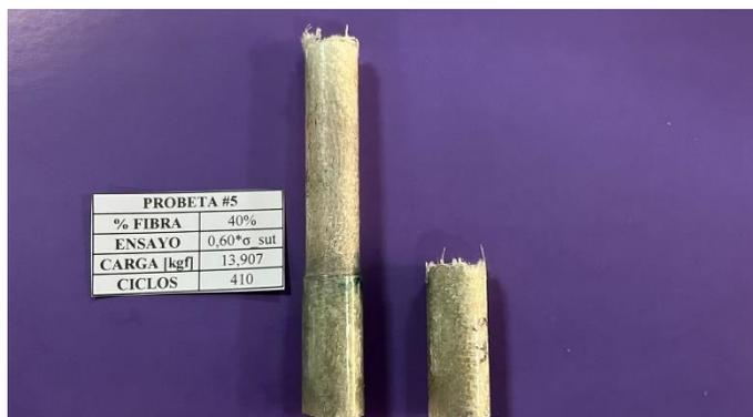
**Análisis:** En la figura #51, la probeta trabajó al 60% del esfuerzo último a tracción, la falla por rotura se produjo a los 410 ciclos con una carga aplicada de 13,907 [kgf], la ubicación de la rotura se da al final del cambio de sección de la longitud de trabajo con el diámetro de refuerzo, motivo por el cual en ese punto existió un concentrador de esfuerzos.
