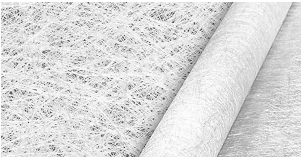
*Nota.* La imagen hace referencia al tipo de fibra de vidrio tipo E. Tomado de *Tipos de Fibra de Vidrio*, por (Yuridia, n.d.), PLAREMESA (<https://www.plaremesa.net/tipos-de-fibra-de-vidrio/>).
