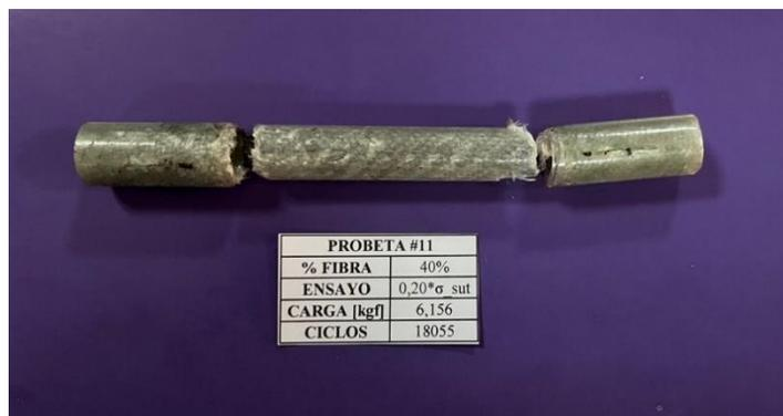
**Análisis:** En la figura #53, la probeta trabajó al 20% del esfuerzo último a tracción, la falla por rotura se produjo a los 18055 ciclos con una carga aplicada de 6,156 [kgf], la rotura se genera en los dos cambios de sección de los diámetros, esto predice que los concentradores de esfuerzos influyeron en el desprendimiento de material.
