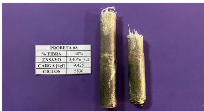
**Análisis:** En la figura #52, la probeta trabajó al 40% del esfuerzo último a tracción, la falla por rotura se produjo a los 5830 ciclos con una carga aplicada de 9,425 [kgf], se observa la generación de una zona de coloración blanquecina en la parte del corte por lo que la falla tiene de comportamiento polimérico por lo que se predice que empezó la falla por matriz(resina).
