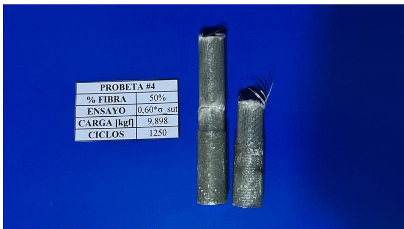
**Análisis:** En la figura #46, la probeta trabajó al 60% del esfuerzo último a tracción, la rotura se produjo a los 1250 ciclos con una carga aplicada de 9,898 [kgf]; existen dos tipos de falla una completa y otra incompleta en la longitud de trabajo de la probeta de material compuesto.
