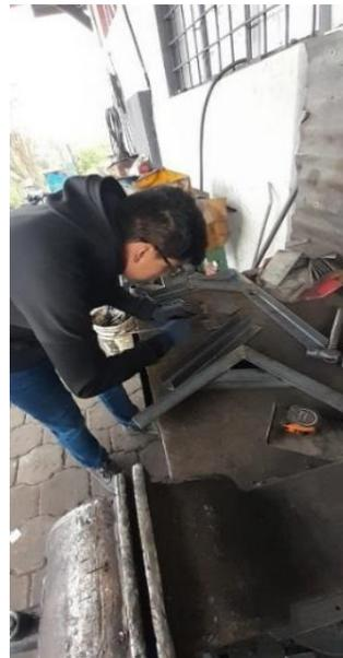
Se realiza el trazado de medidas en el perfil de 6 metros, para obtener las bases (2 componentes), nervios (4 componentes) y placas superiores (3 componentes).
