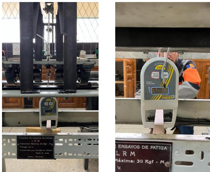
*Nota.* Implementación del sistema de medición de carga que se aplica en la máquina de ensayos de fatiga del Laboratorio de Mecánica de Materiales para su respectiva calibración.
