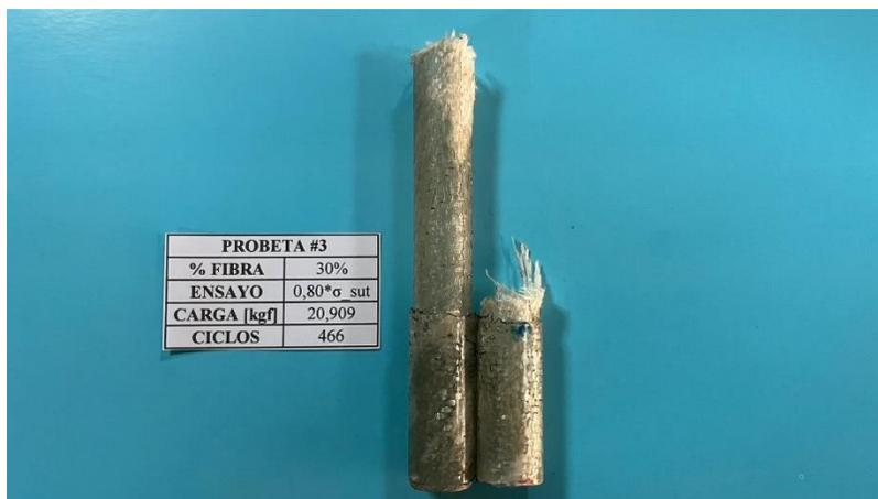
**Análisis:** En la figura #55, la probeta trabajó al 80% del esfuerzo último a tracción, la falla por rotura se produjo a los 466 ciclos con una carga aplicada de 20,909 [kgf], se observa que la rotura fue ocasionada por falla en fibra, justo en el cambio de sección de la probeta.
