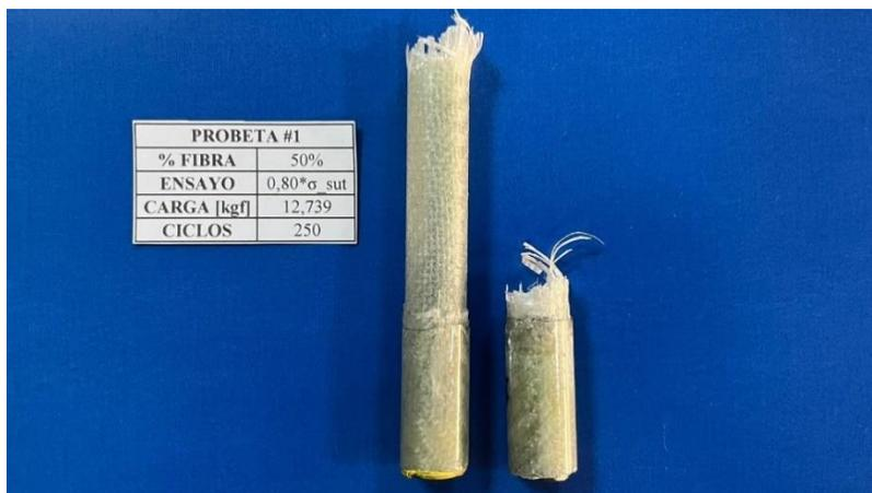
**Análisis:** En la figura #45, la probeta trabajó al 80% del esfuerzo último a tracción, la rotura se produjo a los 250 ciclos con una carga aplicada de 12,739 [kgf], la falla se genera a un extremo del área de trabajo prediciendo que falla por fibra en dirección longitudinal.
