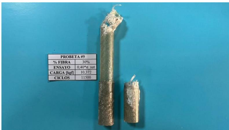
**Análisis:** En la figura #57, la probeta trabajó al 40% del esfuerzo último a tracción, la falla por rotura se produjo a los 11500 ciclos con una carga aplicada de 10,372 [kgf], se generó dos tipos de falla por fibra y matriz(resina) siendo la de fibra la de mayor afección.
