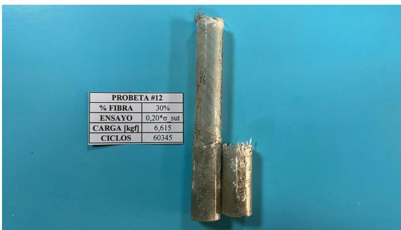
**Análisis:** En la figura #58, la probeta trabajó al 20% del esfuerzo último a tracción, la falla por rotura se produjo a los 60345 ciclos con una carga aplicada de 6,615 [kgf], la rotura se generó en el concentrador de esfuerzo que se ubica al extremo de la probeta.
