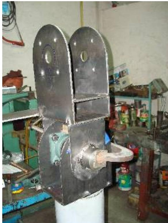
**Figura 5.3** Bastidor primario y bastidor secundario sobre el soporte principal
