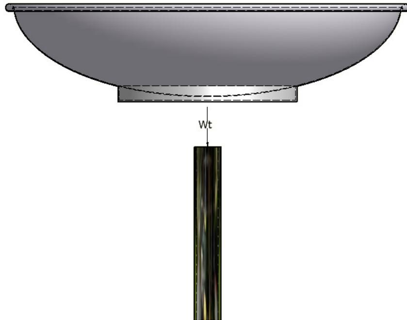
**Figura 4.1** Esquema de la carga concéntrica sobre la columna
