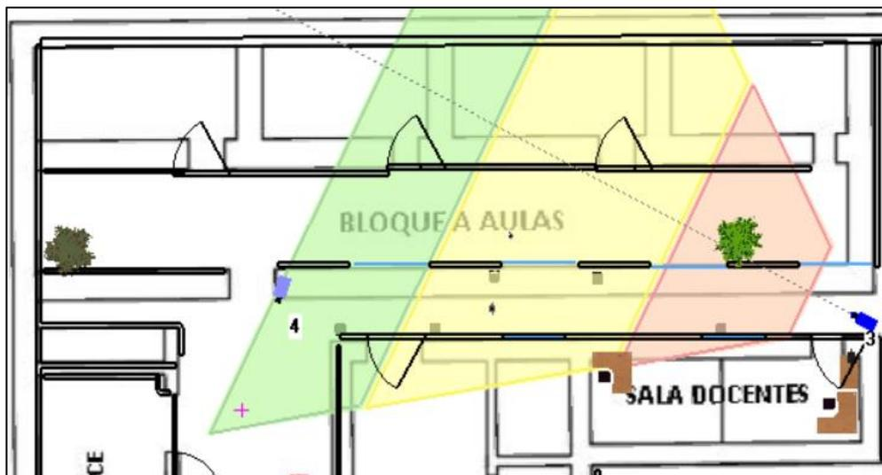
*Nota.* La figura representa la visualización del plano en 2D de la cámara a implementar en el área de Bloque Aulas A.
