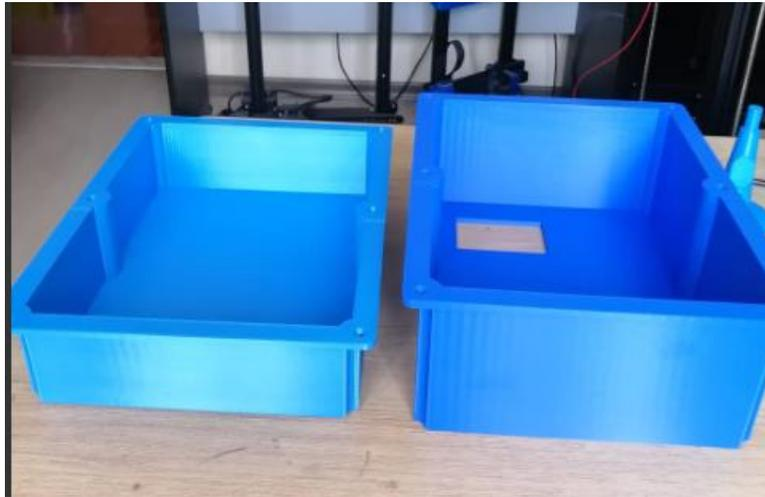
*Nota.* En la imagen se puede observar la nueva caja de protección para el circuito electrónico de control.
