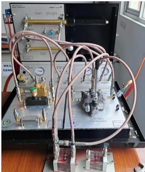
*Nota.* Implementación del circuito 3, utilizando las nuevas válvulas que sustituyeron módulo de hidráulica básica e hidráulica avanzada.
