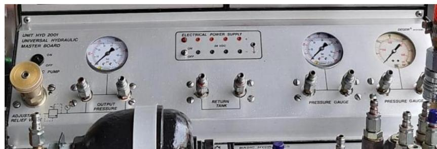
*Nota.* Tablero maestro de sistema hidráulico, donde se puede observar las conexiones de alimentación a 24 Volts DC y el manómetro en mal estado.
