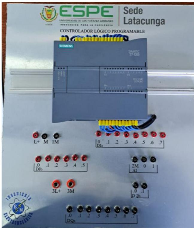
*Nota.* En la imagen se muestra el nuevo módulo PLC implementado con el Controlador S7 – 1214C DC/DC/DC.
