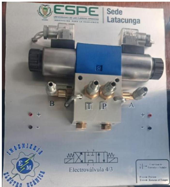
*Nota.* En la imagen se puede observar la implementación del nuevo módulo hidráulico con sus respectivas electroválvulas 4/3 accionada por solenoide y retorno por muelle.
