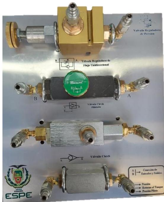
*Nota.* Como se puede observar en el estado de los componentes de la **Tabla 6**, las válvulas del módulo hidráulica básica se encontraban con muchos errores, por lo que la mejor opción fue optar por la sustitución de estos componentes.
