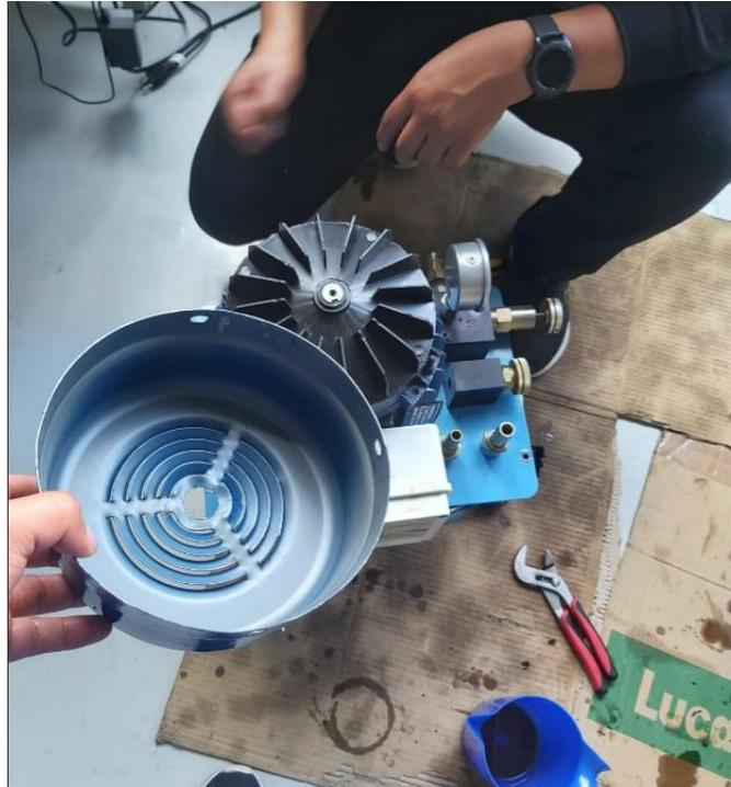
*Nota.* En la imagen se puede observar el desmontaje del motor de la bomba hidráulica para limpiar y observar si todos los sistemas están en orden.
