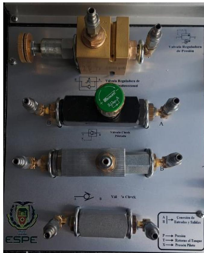
*Nota.* En la imagen se puede observar el nuevo módulo hidráulico con sus respectivas válvulas implementado.
