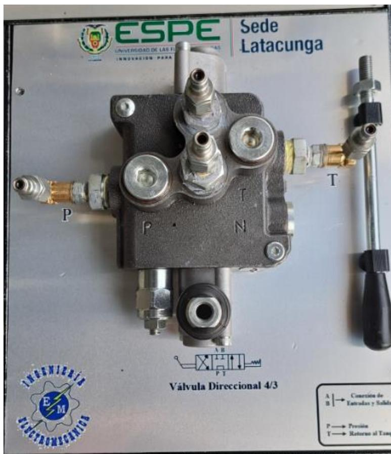
*Nota.* En la imagen se puede observar la implementación del módulo hidráulico con su válvula direccional 4/3 por accionamiento manual o de palanca y retorno por muelle.
