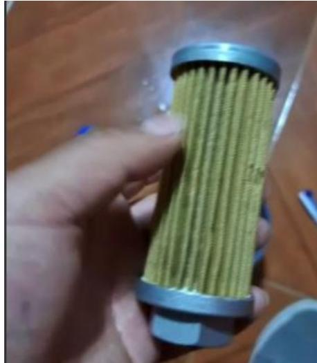
*Nota.* Filtro de aceite que va a ser implementando en el tanque de almacenamiento del sistema hidráulico.
