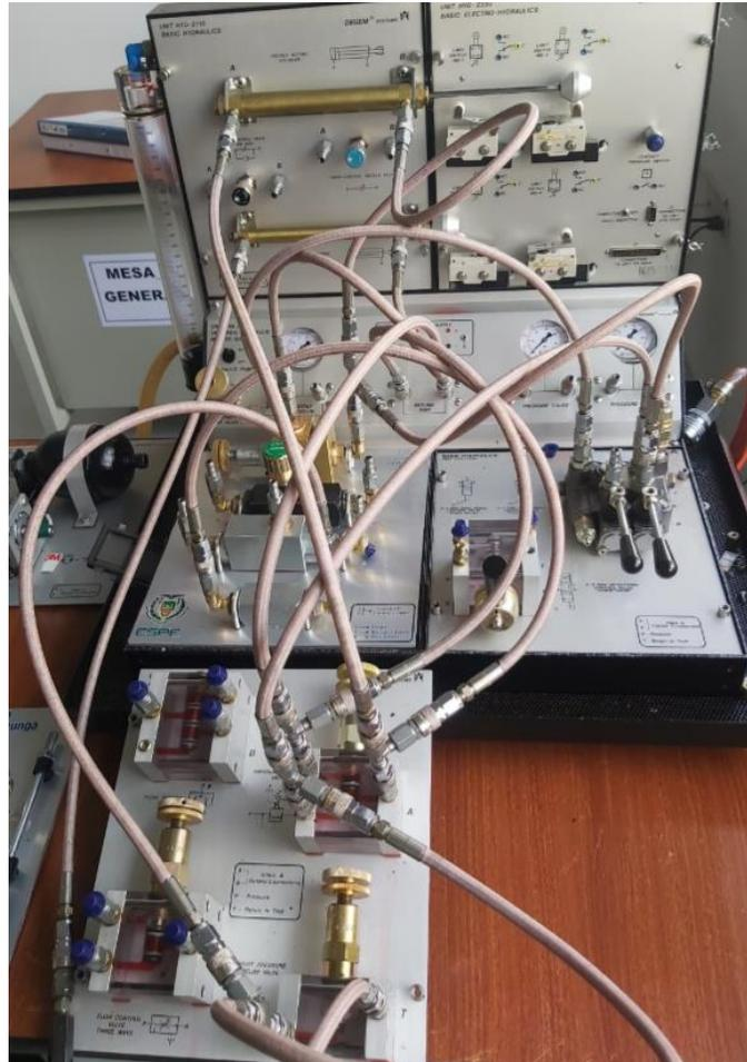
*Nota.* Implementación del circuito 2, utilizando las nuevas válvulas que sustituyeron módulo de hidráulica básica e hidráulica avanzada.
