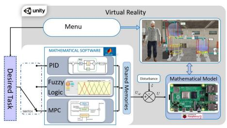
Fig. 4. Esquema propuesto del simulador virtual mediante HIL
