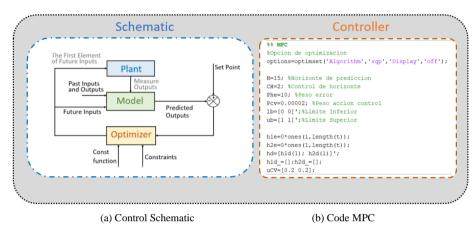
Fig. 7. MPC Controller
