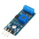
Nota. La figura representa el módulo detector SW-420 de vibraciones. Tomado de (MÓDULO SENSOR DE VIBRACIÓN NC SW-420 – Grupo Electrostore, s. f.)
