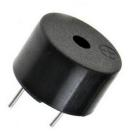
Nota. La figura representa un buzzer el cuál actuará como la alarma del sistema. Tomado de (Buzzer Activo - 5V, 12x9.5mm, s. f.)
