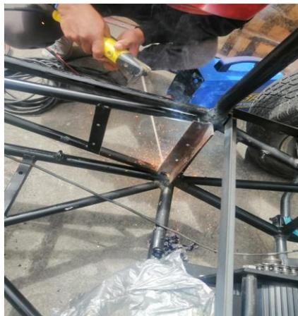
*Nota.* En la figura 21 se indica la base soldada para la ubicación del controlador
