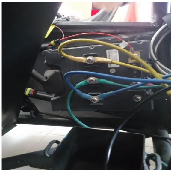
*Nota.* En la figura 17 se puede observar el controlador vector 500 serie y su cableado de conexión.
