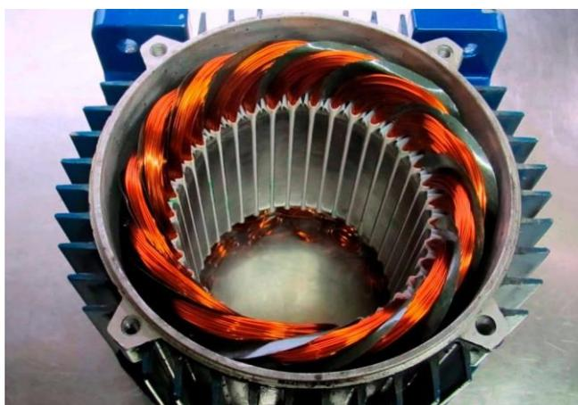
*Nota.* En la figura 10 indica el bobinado de un motor eléctrico. Tomado de (Rubilar, 2022)
