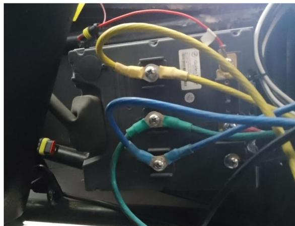
*Nota.* En la figura 19 se identifica la conexión de los cables del motor hacia el controlador y se realiza su respectiva desconexión.
