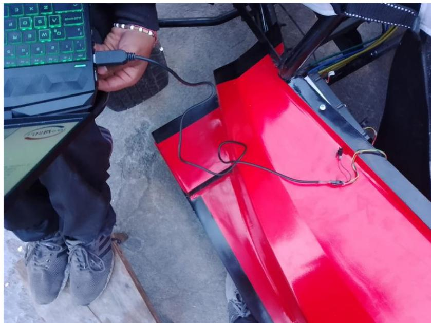
*Nota.* En la figura 29 se muestra de conexión del controlador y el computador para su respectiva programación
