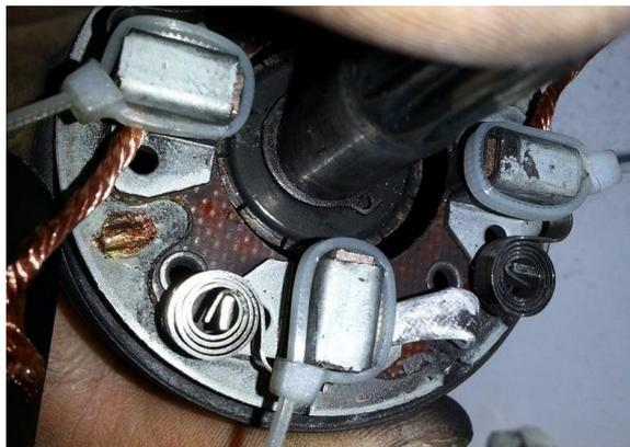
*Nota.* En la figura 9 se indica las escobillas del motor eléctrico. Tomado de (Ruta, 2021)
