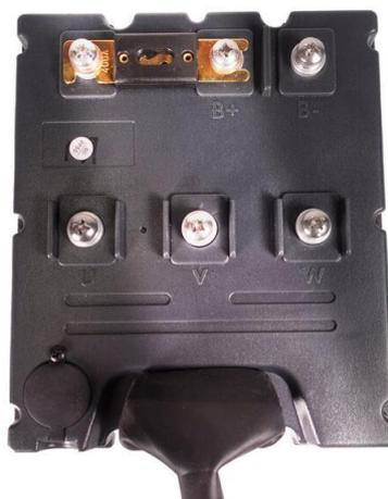
*Nota.* En la figura 16 se muestra el controlador trifásico que ha sido implementado en el prototipo de competición. Tomado de (GoldenMotor, 2023)
