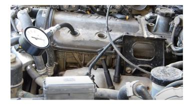
Nota. Prueba de compresión de los 4 cilindros
