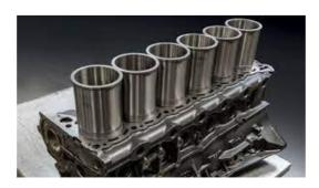
Nota. En la imagen se muestra los cilindros o camisas de un bloque de cilindros. Tomado de (Salinas, 2018)
