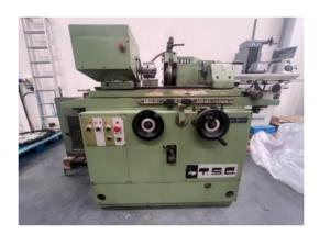
Nota. rectificadora de cilindros. Tomado de Taller rectificado - 2 rectificadoras cilíndricas y fresadora manual. (s/f). Solostocks.com. Recuperado el 12 de junio de 2023, de https://www.solostocks.com/venta-productos/maquinas-herramienta-metal/otras-maquina-herramienta/taller-rectificado-2-rectificadoras-cilindricas-y-fresadora-manual-42689914
