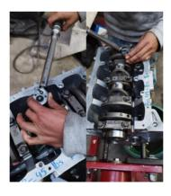
Nota. Apriete de pernos del cigüeñal con torquímetro.
