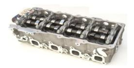
Nota. En la imagen se muestra una culata de un motor de combustión interna. Tomado de (Escobar, 2021)
