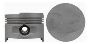
Nota. En la imagen se puede apreciar el pistón de un motor de combustión interna. Tomado de (Lopez, 2021b)
