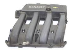
Nota. En la imagen se puede apreciar el múltiple o colector de admisión de un motor de combustión interna. Tomado de (López & Vásquez, 2007)
