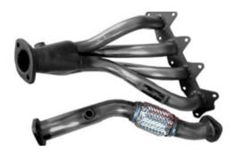
Nota. En la imagen se puede apreciar el múltiple de escape de un motor de combustión interna.
