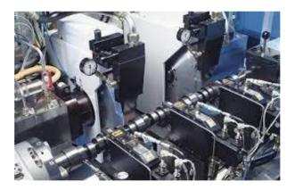
Nota. Rectificadoras de árbol de levas. Tomado de Rectificado no cilíndrico de formas de levas con tecnología CBN. (s/f). Emag.com. Recuperado el 12 de junio de 2023, de https://www.emag.com/es/sectores-y-soluciones/tecnologias/rectificado-no-cilindrico/
