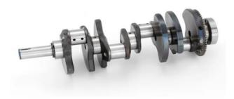
Nota. En la imagen se puede apreciar el cigüeñal de un motor de combustión interna. Tomado de (Blazquez, 2020)
