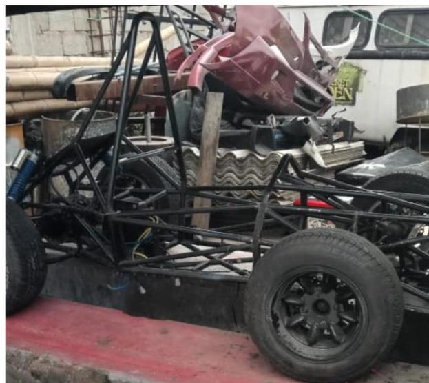
En esta imagen se procedió a retirar toda la parte que cubrían al SAE eléctrico (carcasa) para poder tener una mejor vista del chasis y modificarlo correctamente.
