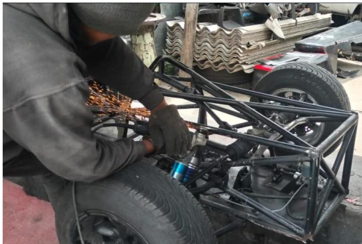
Para este procedimiento se utilizó una moladora para realizar los cortes correspondientes del SAE eléctrico, debido a que en la parte del volante este no contaba con la respectiva normativa de protección por ende se realizó los cortes necesarios para añadir otro tipo de tubo más ligero y modificar esa zona para que el piloto este seguro.
