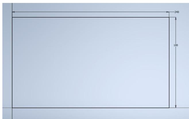
Se empezó a dibujar las limitaciones de los agarres del volante en el boceto, se representó los agarres del volante con rectángulos para poder realizar la extrusión sin tener ningún inconveniente.
