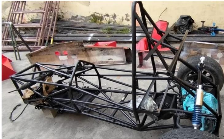
*Nota.* Al finalizar el procedimiento de pintura se puede visualizar el resultado final del chasis tubular del vehículo formula SAE eléctrico con unos acabados geniales.
