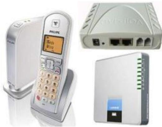
Una Gateway VoIP o Gateway Voz IP, es un dispositivo de red que ayuda a convertir las llamadas de voz, en tiempo real, entre una red IP y la red telefónica pública conmutada o su centralita digital.
