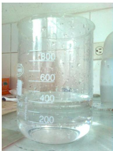
**Figura 4.15. Vaso de Precipitados en 400 ml**
