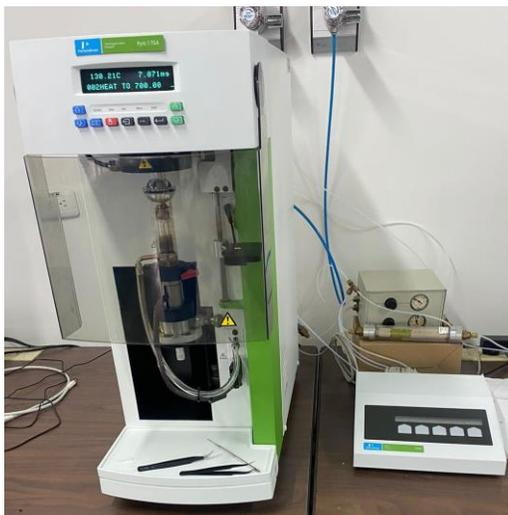
*Nota.* Equipo de análisis termogravimétrico (TGA).
