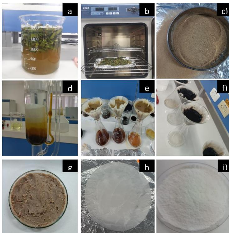
*Nota.* Representación gráfica del cambio de apariencia de los residuos de tallo de tomate en cada proceso, a) lavado con NaClO a 50°C, b) secado a 105 °C, c) tamizaje 450 um, d) extraíbles (etanol al 96%), e) precipitación de hemicelulosas (etanol y ajuste de pH a 6M), f) lignina tratada con  $H_2SO_4$  al 72%, g) celulosa tratada con NaOH al 17.5%, seca 65 °C durante 24h, h) celulosa blanqueada con NaClO durante 2h, i) celulosa triturada.
