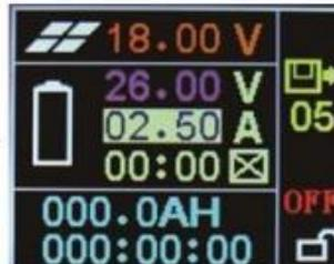
Presionar **SET** para seleccionar el amperaje y **▲ ▼** configurarlo
