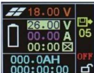
Presionar **▲ ▼** para configurar el voltaje
