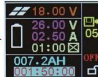
Presionar **SET** y **▲ ▼**, configurar el tiempo de carga para que el sistema se detenga.
