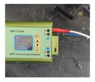
Nota. En la figura se observa ya conectados los bornes del panel solar mediante cable número 12 y terminal de tipo uña.
