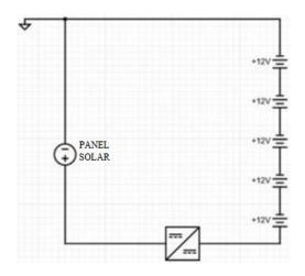
Nota. Diagrama de conexión paneles y controlador con baterías en serie. Tomada de "Incremento de Autonomía de un vehículo eléctrico Dayang CHOK-S mediante paneles solares" Reinoso Luis, Ortega Juan. https://novasinergia.unach.edu.ec
