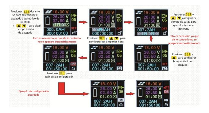
Nota. En la figura se observa el proceso final de configuración del controlador.
