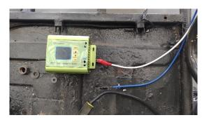
Nota. En la figura se observa el controlador encendido y colocado en el piso bajo el asiento del buggy.
