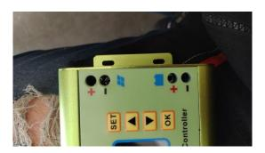
Nota. En la figura se observa la señalización correcta de conexión de los cables del sistema de carga en el controlador.
