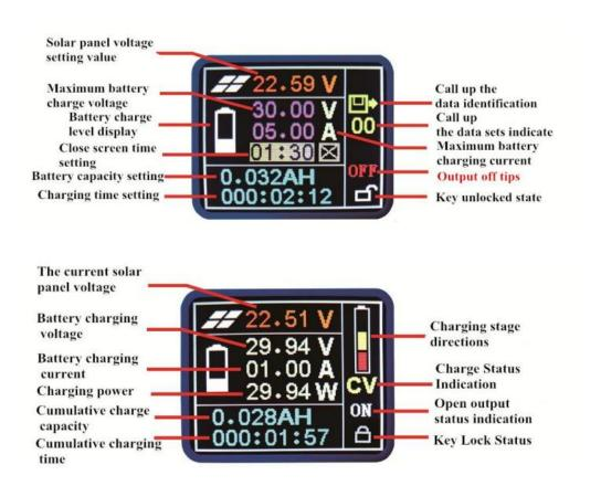
Nota. En la figura se observa las especificaciones del display del controlador. Tomada de "MPT-7210A" MSC,2018, https://drive.google.com/file/d/0B0YFKHja1GO1YXptR3
