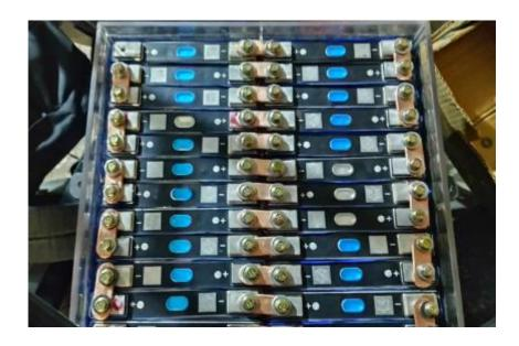
*Nota.* En la figura se observa las 24 baterías conectadas en serie mediante platinas de cobre con dos bornes libres en la parte izquierda para el controlador.
