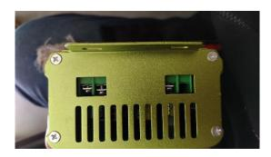
Nota. En la figura se observa los bornes mediante ajuste de tornillo del controlador.
