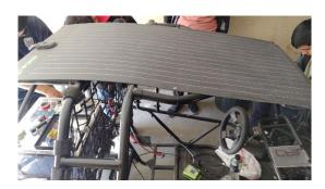
Nota. En la figura 6 se observa el panel semiflexible ya colocado mediante seguros en el techo del buggy.
