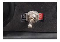
Nota. En la figura se observa el interruptor que permitirá la conexión y desconexión del circuito de carga a las baterías.
