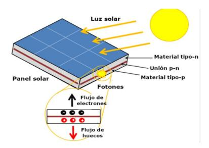
Nota. El efecto fotovoltaico es la generación de electricidad en una célula fotovoltaica cuando recibe luz solar. Tomada de "Células fotovoltaica" Energy Education, 2021, https://energyeducation.ca/es/Célula\_fotovoltaica.
