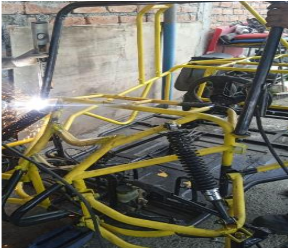
Soldadura de puntos en las fijaciones
