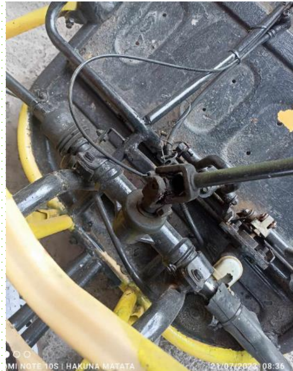
Mecanismo de dirección e instalación de guardapolvos
