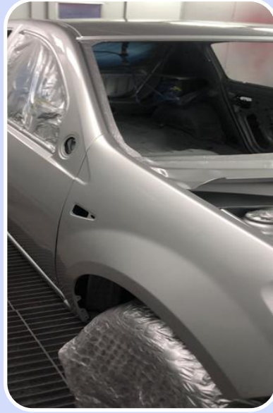
Aplicación de capa base
