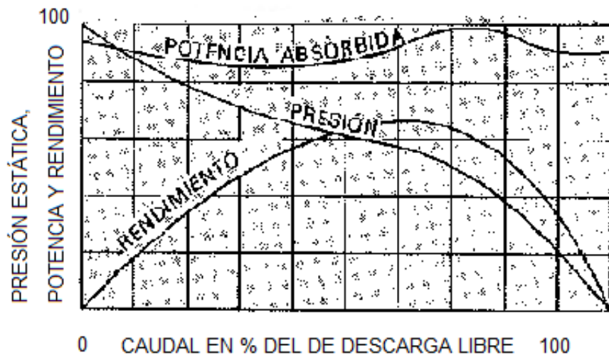
Figura 2.22 Curvas Características de un ventilador de aletas axiales
