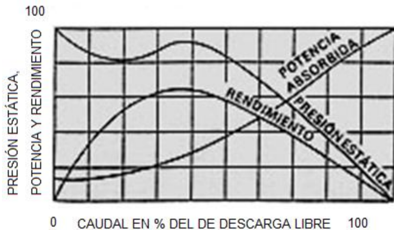
Figura 2.19 Curvas Características de un ventilador de aletas hacia adelante
