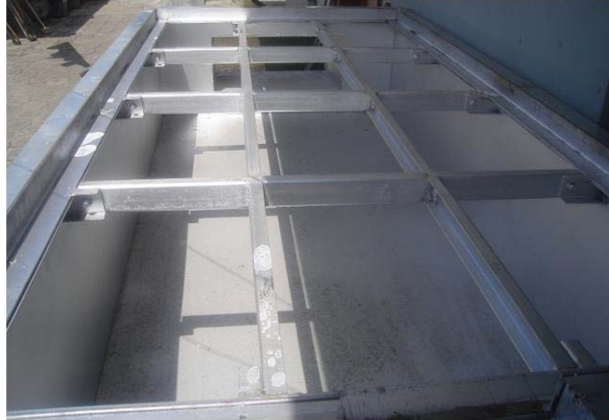
Figura 5.14 Estructura de fijación para plancha perforada.
