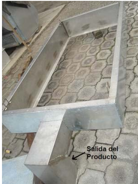
Figura 5.16 Paredes de contención del producto y boca de descarga
