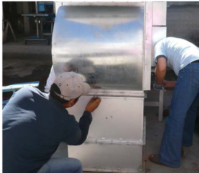
Figura 5.18 Constitución de junta empernada
