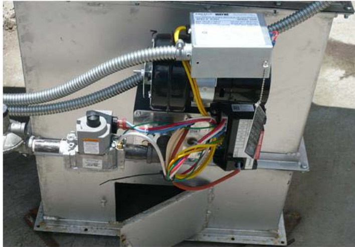
Figura 5.22 Ensamblaje de quemador
