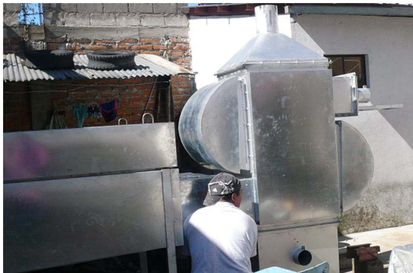
Figura 5.20 Ensamblaje de Intercambiador de Calor con Cámara de Secado.
