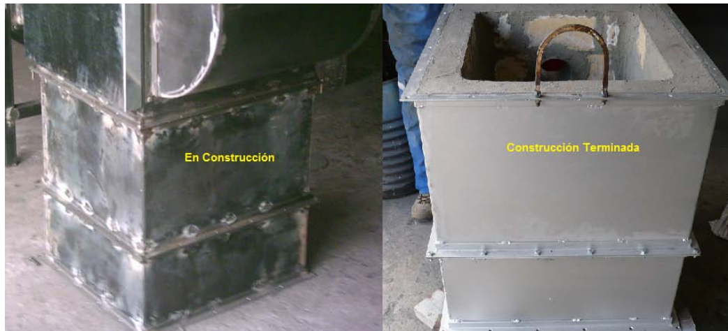
Figura 5.6 Base y cámara de combustión.
