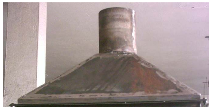
Figura 5.10 Chimenea de gases de combustión.
