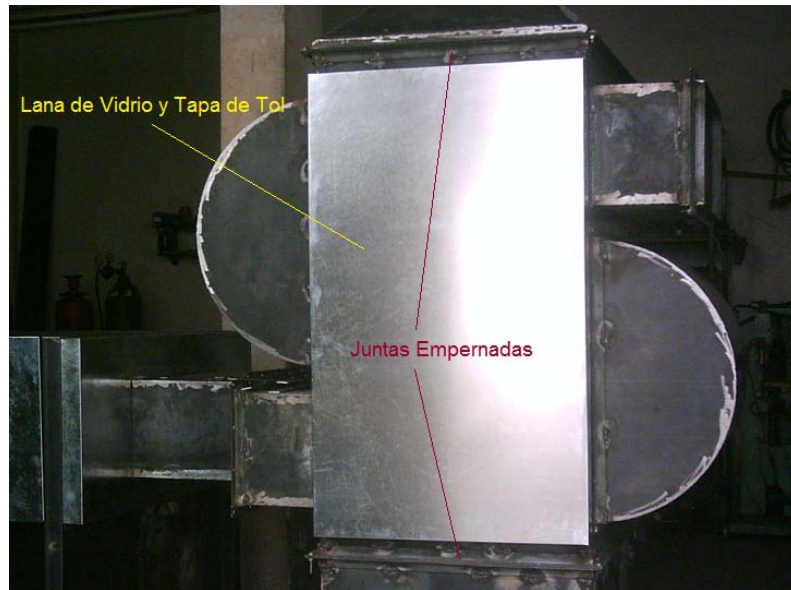
Figura 5.9 Aislamiento térmico y juntas.
