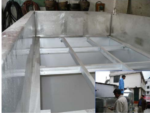
Figura 5.29 Bastidor resistente al peso de un operador
