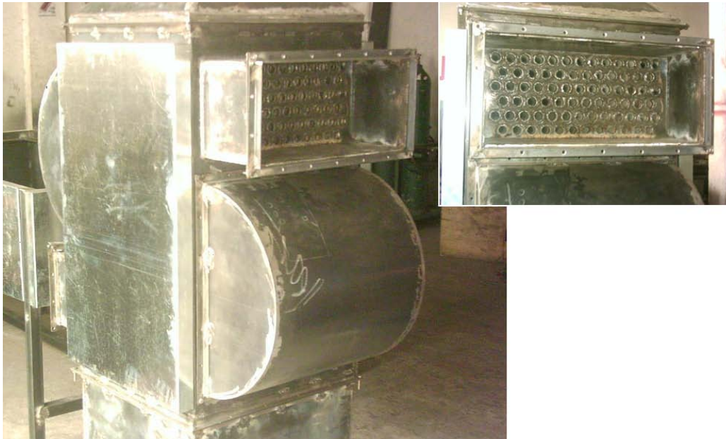
Figura 5.8 Carcasa y Placas soporte de tubos del serpentín.
