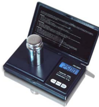
Figura 6.8 Balanza digital utilizada para Pruebas
