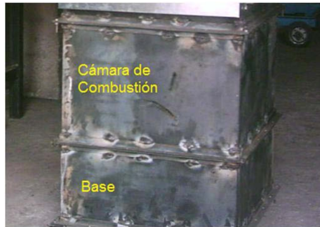
Figura 5.3 Partes de la cámara de combustión.
