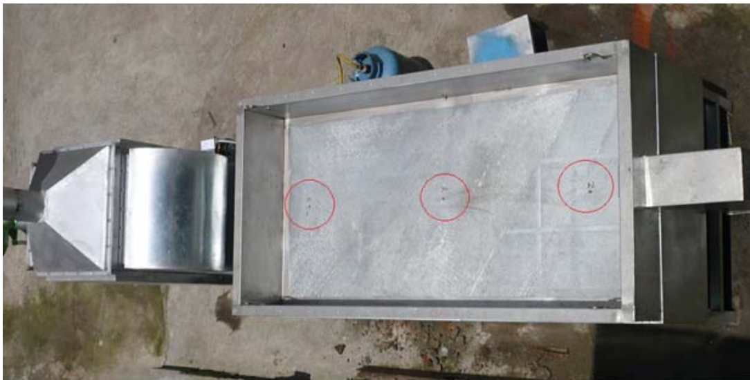
Figura 6.11 Marcación de puntos de medición - Cámara de Secado.
