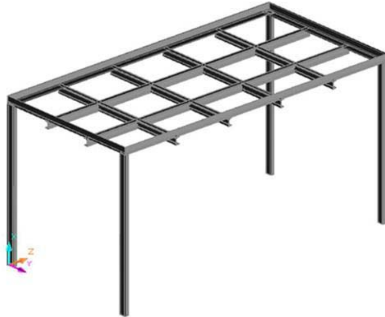
Figura 4.27 Configuración del bastidor a construir (Secador).
