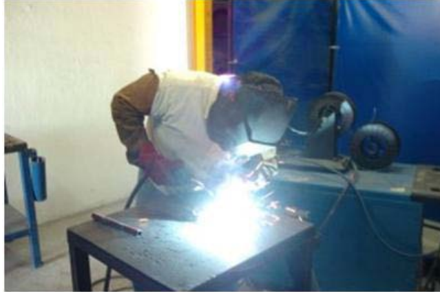
Figura 5.35 Utilización de elementos de seguridad al momento de soldar
